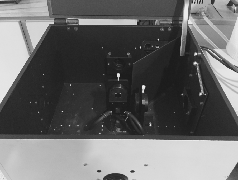
Şekil 4.9 : PTI marka floresans spektrometrenin örnek kompartımanı.
