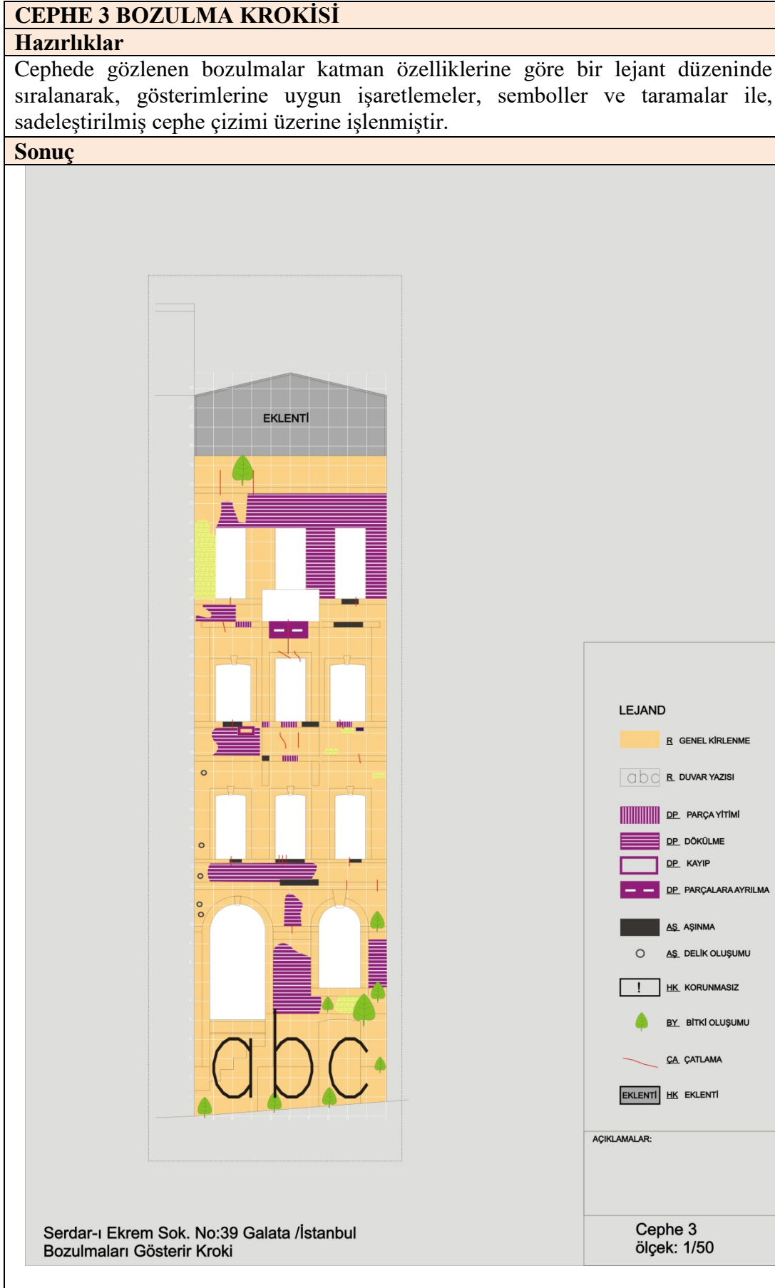
Çizelge 5.6 : Cephe 3 için bozulma krokisi.
