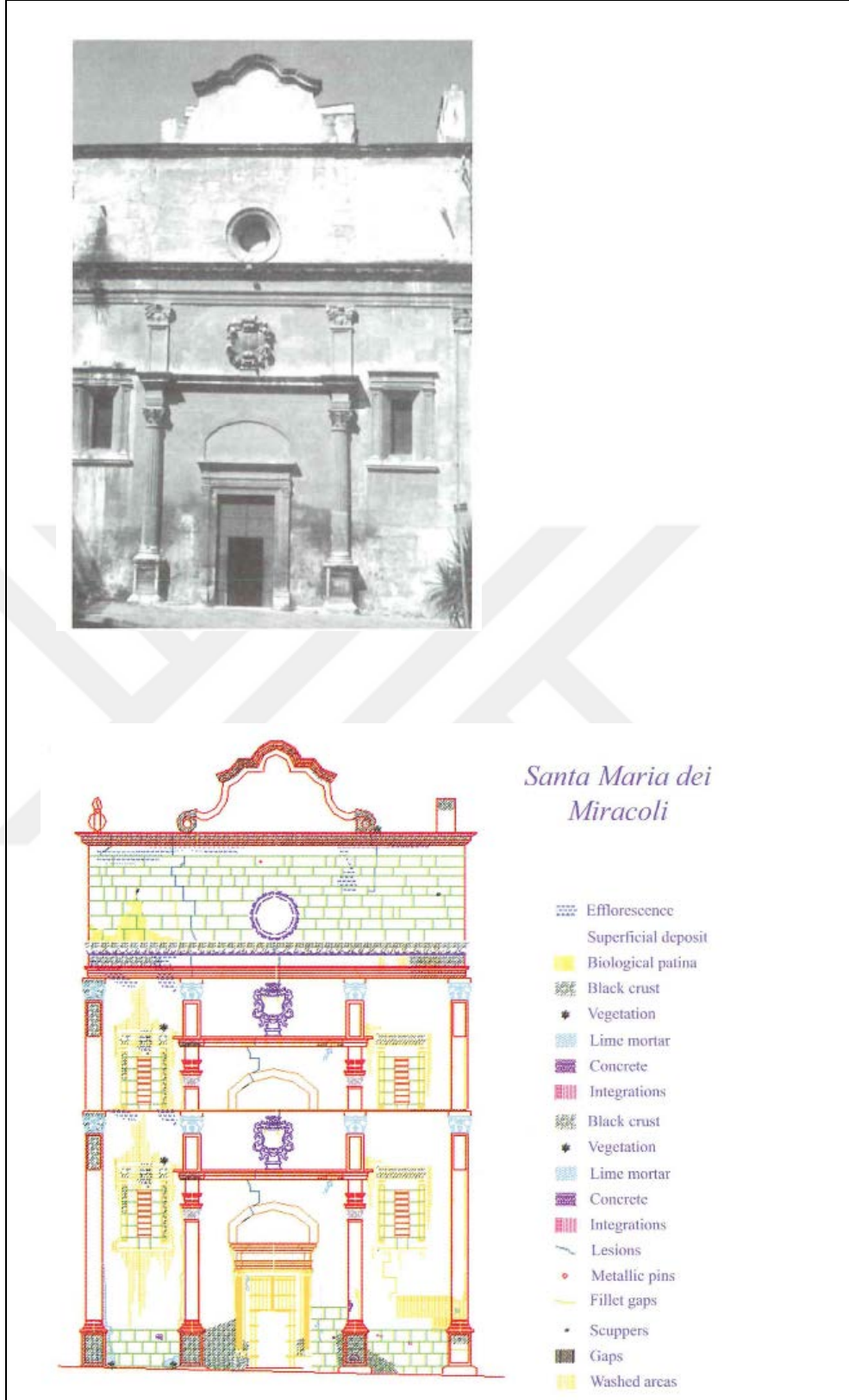
Şekil 3.6 : Santa Maria dei Miracoli Kilisesi ana cephesi fotoğrafı ve hasarlarını gösterir görsel düzenleme (Url-7, s. 7).
