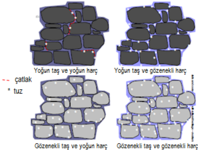
Şekil 2.6 : Taş ve harç ilişkisinde hasar konumunun şematik açıklaması (Url-2).
