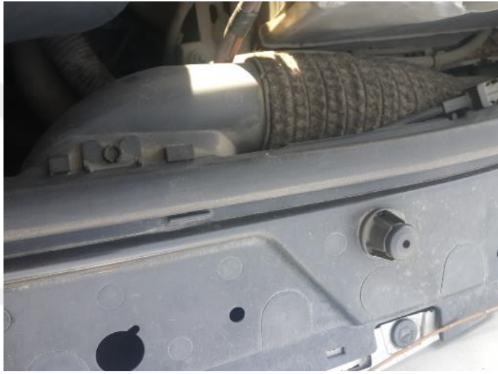
Şekil 1.1 : Poroz malzemenin kirli hava borusu olarak kullanımını
