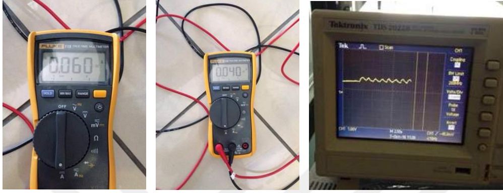
Şekil 6.5 : \text{Bi}_2\text{Se}_3 üzerinden 4K'da 60mA ve 40mA akım geçirildiğinde MKM tarama ucunun faz kayması osiloskop görüntüsü.
