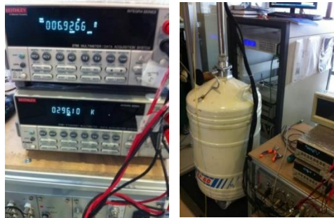
Şekil 4.8 : T_c geçiři gösteren örnekler için Direnç-Sıcaklık ölçen sistem.
