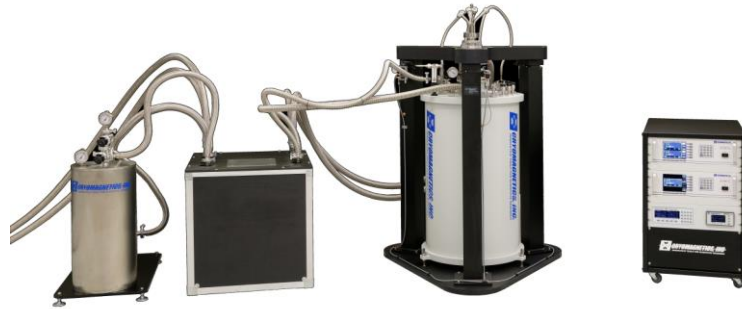
Şekil 2.18 : Deneysel olarak kullanılan kapalı devre soğutma sistemi (kuru kriyostat) örneği, Sistem Soldan sağa: He tankı, kompresör, tank ve kontrol ünitesinden oluşmaktadır [46].
