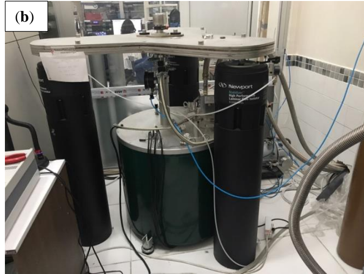
Şekil 4.11 : Tez çalışmasında kullanılan titreşim masası tasarımı ve montajı.
