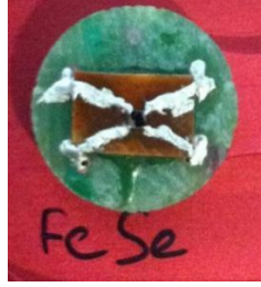
Şekil 5.1 : FeSe Süperiletken numunesi, üzerinde 4 noktadan bağlantı noktası bulunuyor.
