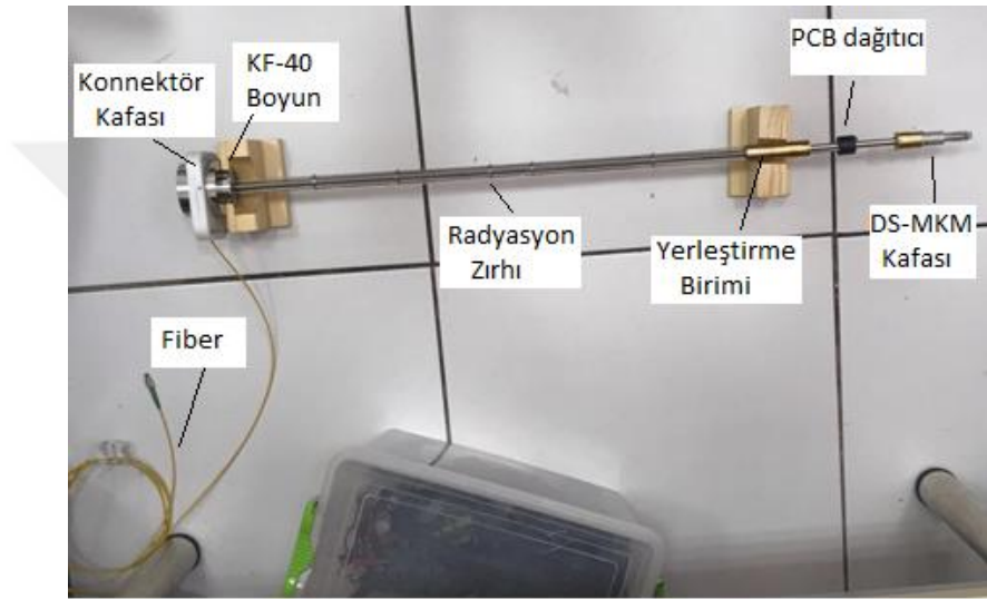
Şekil 2.14 : Düşük sıcaklık taramalı uç mikroskobu bileşenleri.
