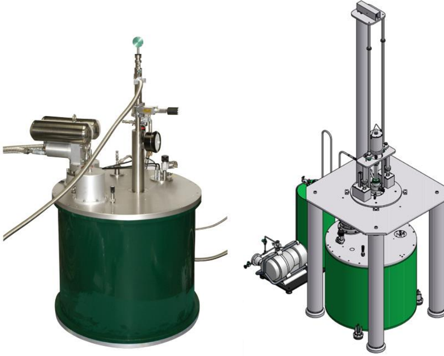
Şekil 4.7 : Deneyleerde kullanılan kapalı devre kriyostat sistemi örneđi, Sistem He tankı, kompresör, tank ve kontrol ünitesinden oluşmaktadır [133].
