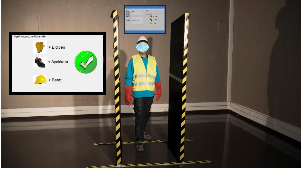
Şekil 24: Paketleme departmanına giriş için zorunlu olan; baret, iş eldiveni ve iş ayakkabılarını tamamladıktan sonra okuyucu kapıdan geçmek isteyen çalışan.
