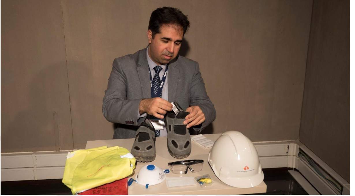
Şekil 3: RFID Etiketlerin Kişisel Koruyuculara Yapıştırılması (İş Güvenliği Ayakkabısı).
