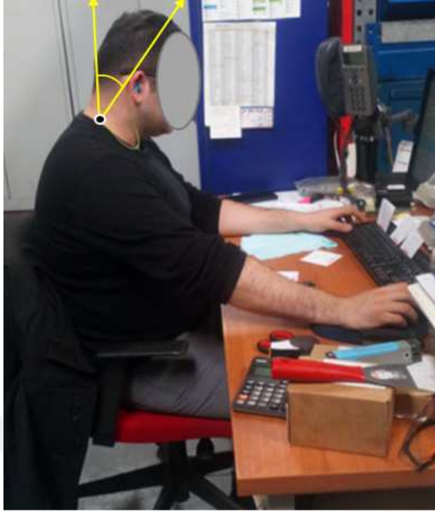
Şekil 1 : REBA Boyun Hareketi Açı Ölçümü
