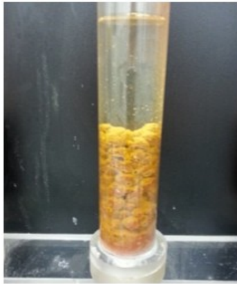
Şekil 7.7 : AMD suyu, kolonda sarı-turuncu demir çökeltileri.
