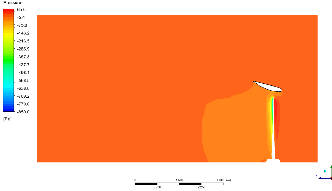
Şekil 5.17: Geometri-1, akış hacmi boyunca görülen basınç konturları ( \lambda=6 ).
