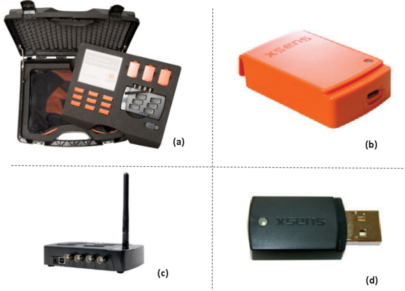
Şekil 3.4 : Kullanılan donanımlar: (a)MTw geliştirme kiti. (b) Hareket algılayıcı sensör. (c)Veri toplama istasyonu. (d) Mini veri toplama donanımı
