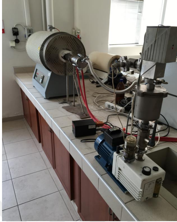
Şekil 4.2 : Protherm marka fırın ve ILMVAC PIA 100 piezoelektrik sensör sistemi. Deneyle esnasında sıcaklık ölçümü 6RhPt-30RhPt (EL-18) termokupl kullanılarak yapılmıştır. Deneyle sistemi şematik olarak Şekil 4.3'te verilmiştir.
