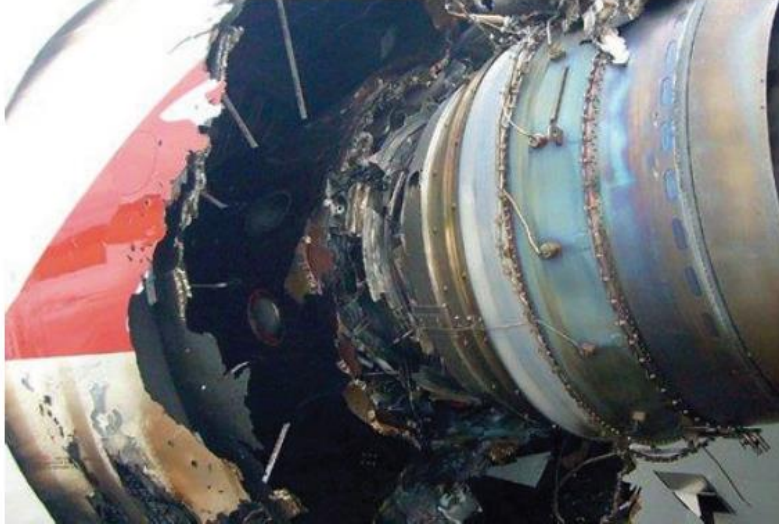
Şekil 1.5: Quantas A380 disk infilakı.
