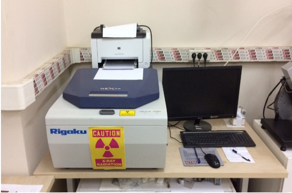
Şekil 3.7: XRF analizi için kullanılan Rigaku marka cihaz.
