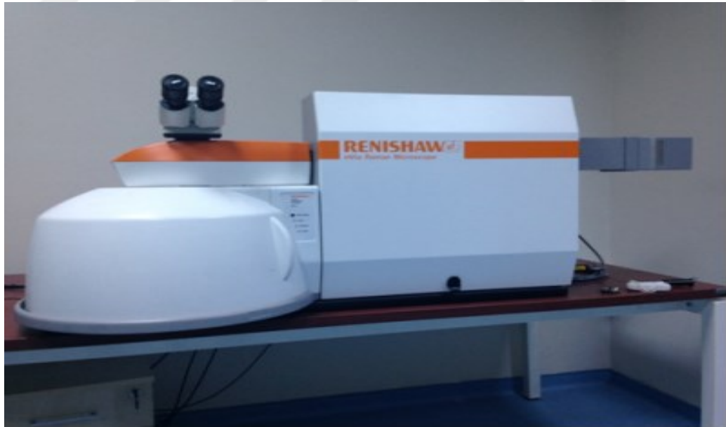
Şekil 3.10: Çöktürülen TiO_2 fazların analizinin yapıldığı Renishaw marka Konfokal Raman Spektroskopi cihazı.
