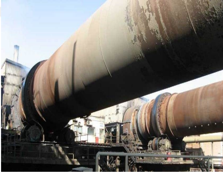
Şekil 2.23: Waelz prosesinde kullanılan döner fırınlardan görünüm [56].
