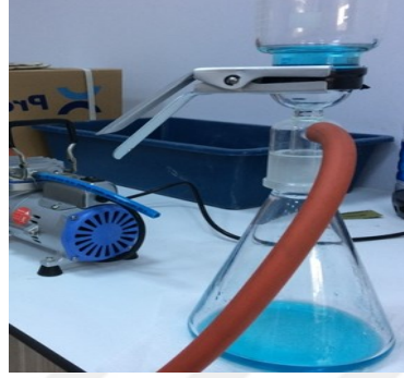
Şekil 3.18: Süzme işlemleri için kullanılan vakumlu seramik filtre.
