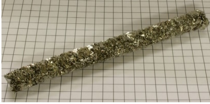
Şekil 2.16: Van Arkel – De Boer yöntemi ile üretilmiş titanyum kristal çubuk [38].
