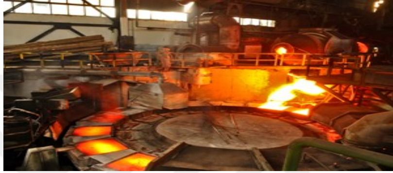
Şekil 2.11: Bakır anot döküm makinesi [23].
