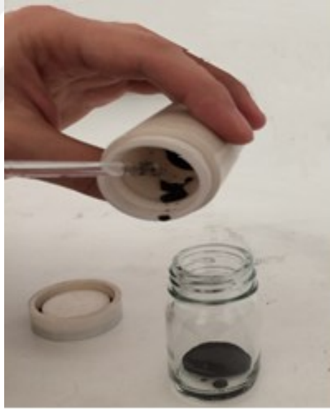
Şekil 4.6: Karıştırmasız otoklav liçi ile elde edilen “black liqueur” olarak isimlendirilen nikel ve titanyum içerikli çözelti.
