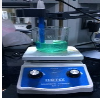
Şekil 3.14: Liç deneylerinde kullanılan manyetik karıştırıcı düzenek.
