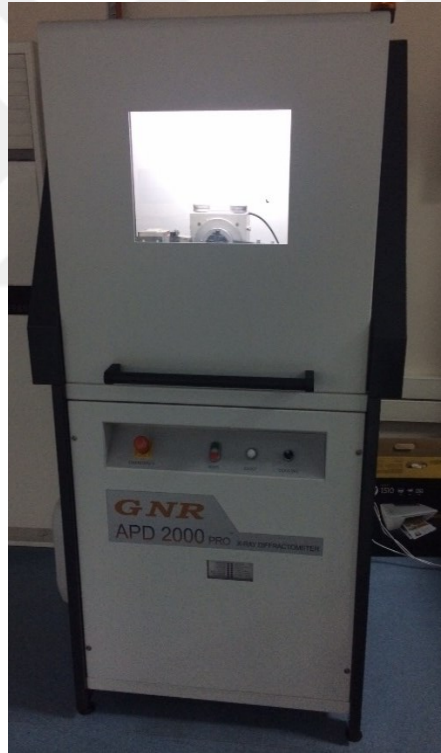
Şekil 3.8: XRD analizi için kullanılan GNR marka cihaz.
