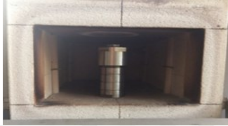
Şekil 3.16: Otoklavlı liç deneylerinde kullanılan karıştırmasız paslanmaz çelik otoklavın fırında kullanılma biçimi.
