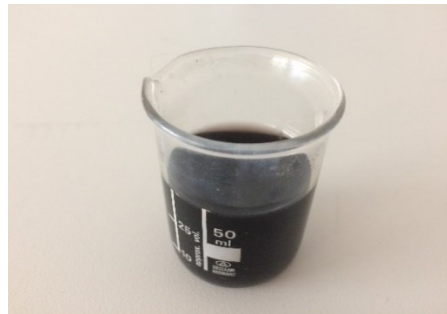
Şekil 4.5: İkincil ısıtma sonucu elde edilen nikel ve titanyum içerikli çözelti.
