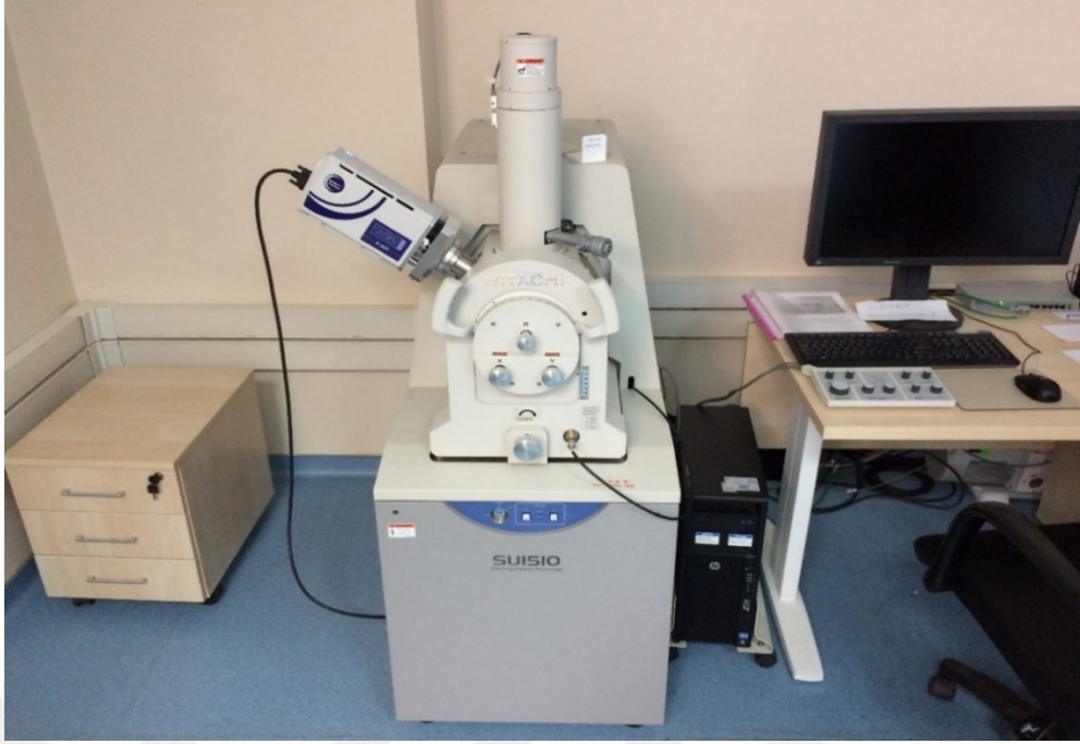
Şekil 3.9: SEM ve EDX analizi için kullanılan HITACHI marka cihaz.
