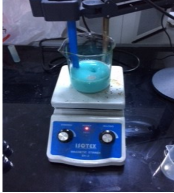
Şekil 3.19: Hidroksit çöktürme deneylerinin yapıldığı manyetik karıştırıcı ve pH metre düzeneği.
