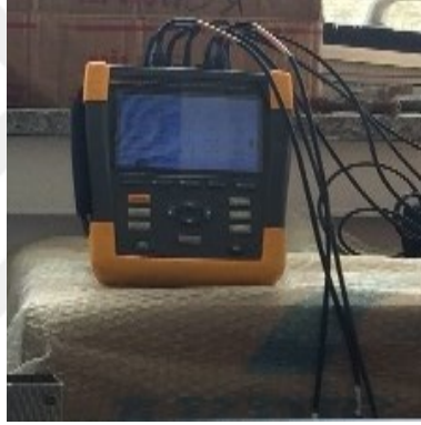
Şekil 3.12: Karıştırmasız otoklav ile yapılan liç işlemlerinde ısıtma esnasında fırın gücünün ölçülmesi için kullanılan cihaz.
