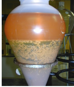
Şekil 2.21: Solvent ekstraksiyon ile altın kazanımı [51].
