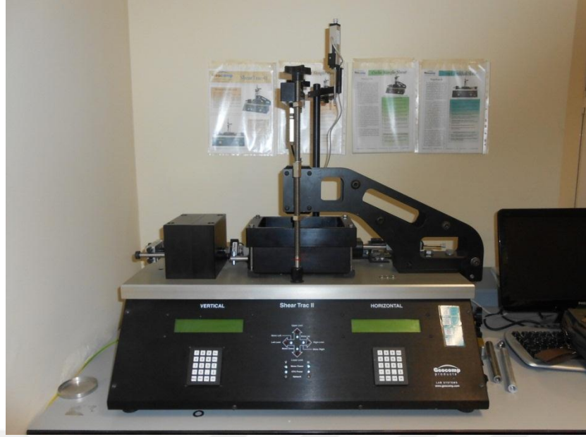
Şekil 2.3 : Bu tez çalışmasında kullanılan, Yeditepe Üniversitesi Zemin Mekaniği Laboratuvarında bulunan ShearTrac-II-DSS basit kesme deney cihazı.
