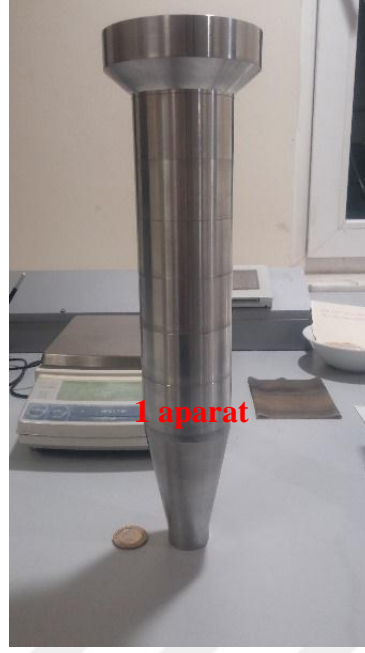
Şekil 5.5: Alüminyum huni ve zemin döküş yüksekliğini belirleyen aparatları.
