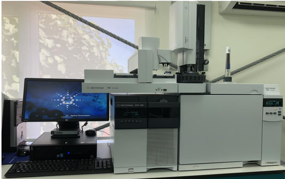
Şekil 3.3. Benzodiazepin analizinin yapıldığı GC-MS cihazının görüntüsü
