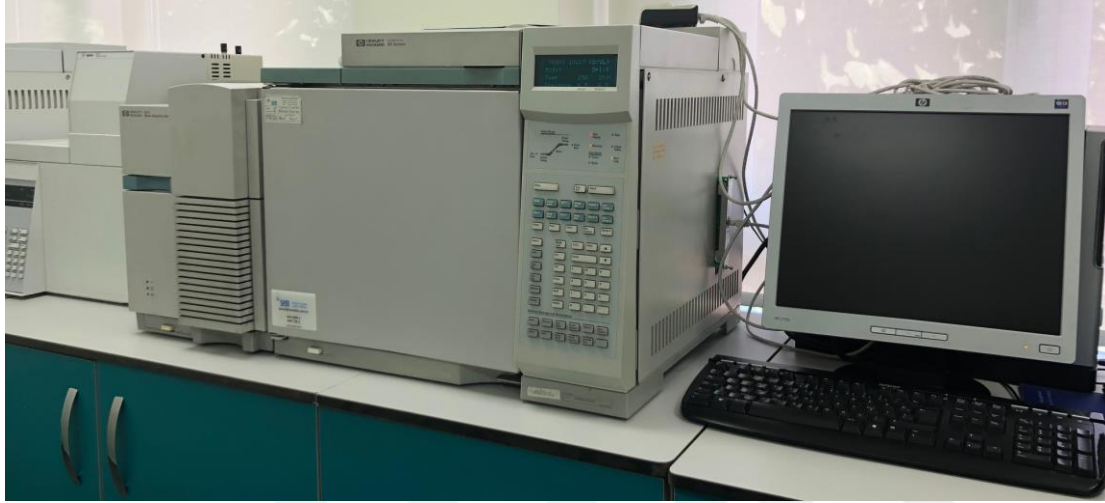
Şekil 3.4. Alkol analizinin yapıldığı HS/GC-MS cihazının görüntüsü
