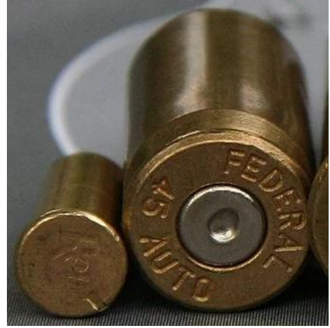
Şekil 4. Çevresel (kenar) vuruşlu mermi ve merkezi vuruşlu mermi (28)
