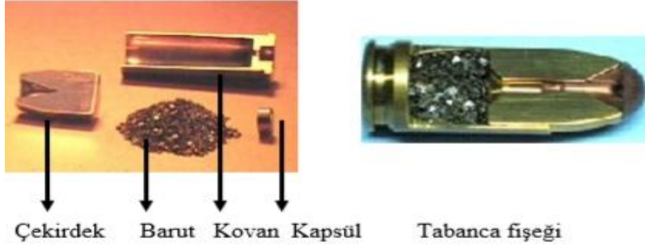
Şekil 3. Bir fişegi oluşturan bileşenlerin kesitsel görüntüsü (27)
