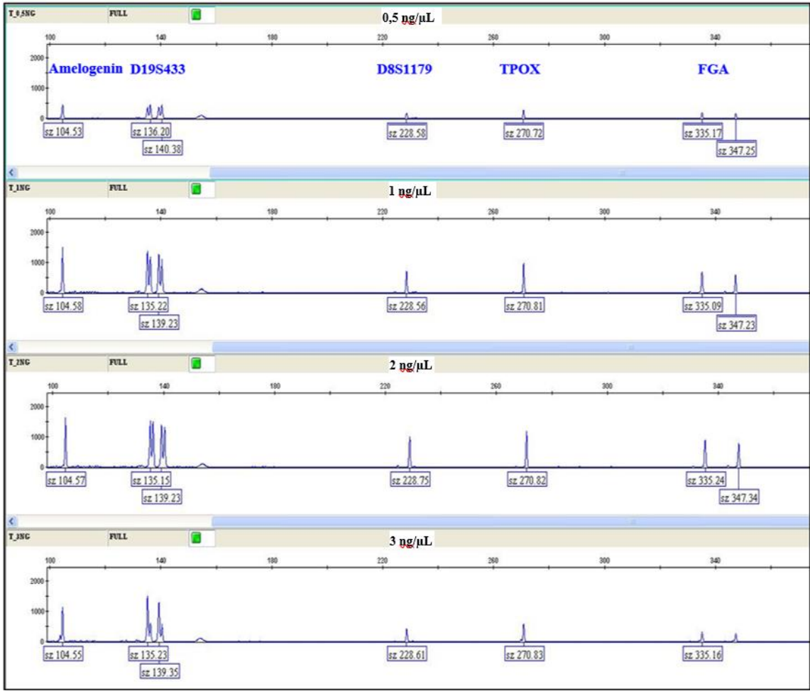
Şekil 32. 6-FAM boyası ile işaretli STR bölgelerinin 0.5 ng/μl, 1 ng/μl, 2ng/μl, 3 ng/μl konsantrasyonlarındaki elektroforam görüntüleri
