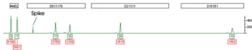
Şekil 15: Spike (voltaj kaynaklı pikler) örneği (52)
