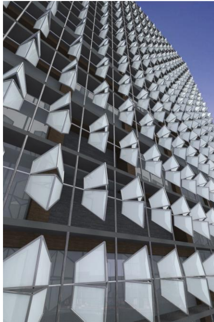
Şekil 4.72 : Simülasyon 6, cephe bileşenleri yakın perspektif görünüşleri.
