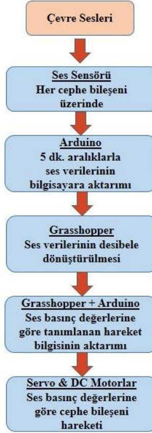
Şekil 4.1 : Önerilen dinamik adaptif cephe sistemi çalışma prensibi.
