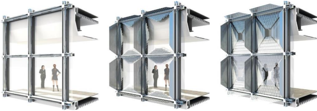
Şekil 3.52 : HelioTrace geri çekilmiş paneller (sol), perfore panellerin açılması (orta), opak panellerin açılması (sağ), (Skidmore ve diğ, 2010).
