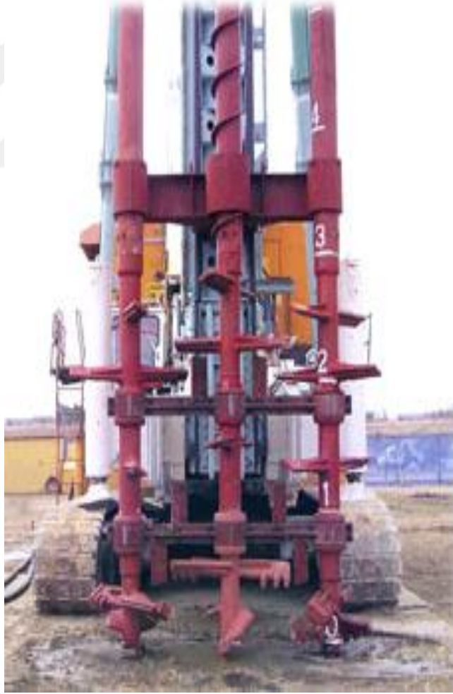
Şekil 3.7 : CDM-Lemni 2/3 yöntemi uygulama makinesi. (Url-6)
