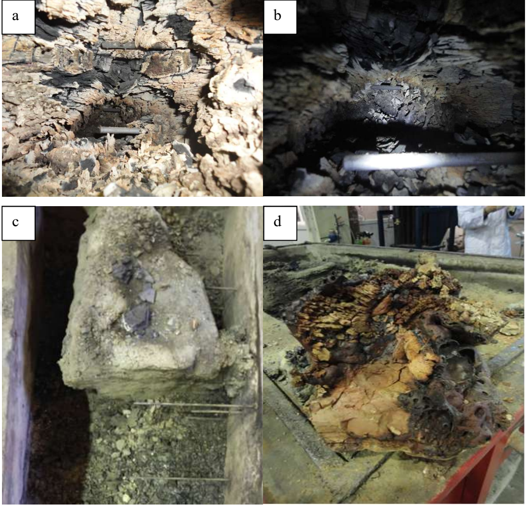
Şekil 5.13: a) Kaviteasyon görünümü. b) Kaviteasyon görünümü. c) Reaktör içerisindeki ikinci blok görünümü. d) Reaktör ön bölgesinden çıkarılan kömür ve kil parçalarının oluşturduğu yapının görünümü.
