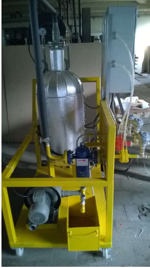
Şekil 3.2: Üfleç, buharlaştırıcı ve oksijen ile azot tüplerinin bulunduğu gazlaştırma ajanı besleme düzeneği.
