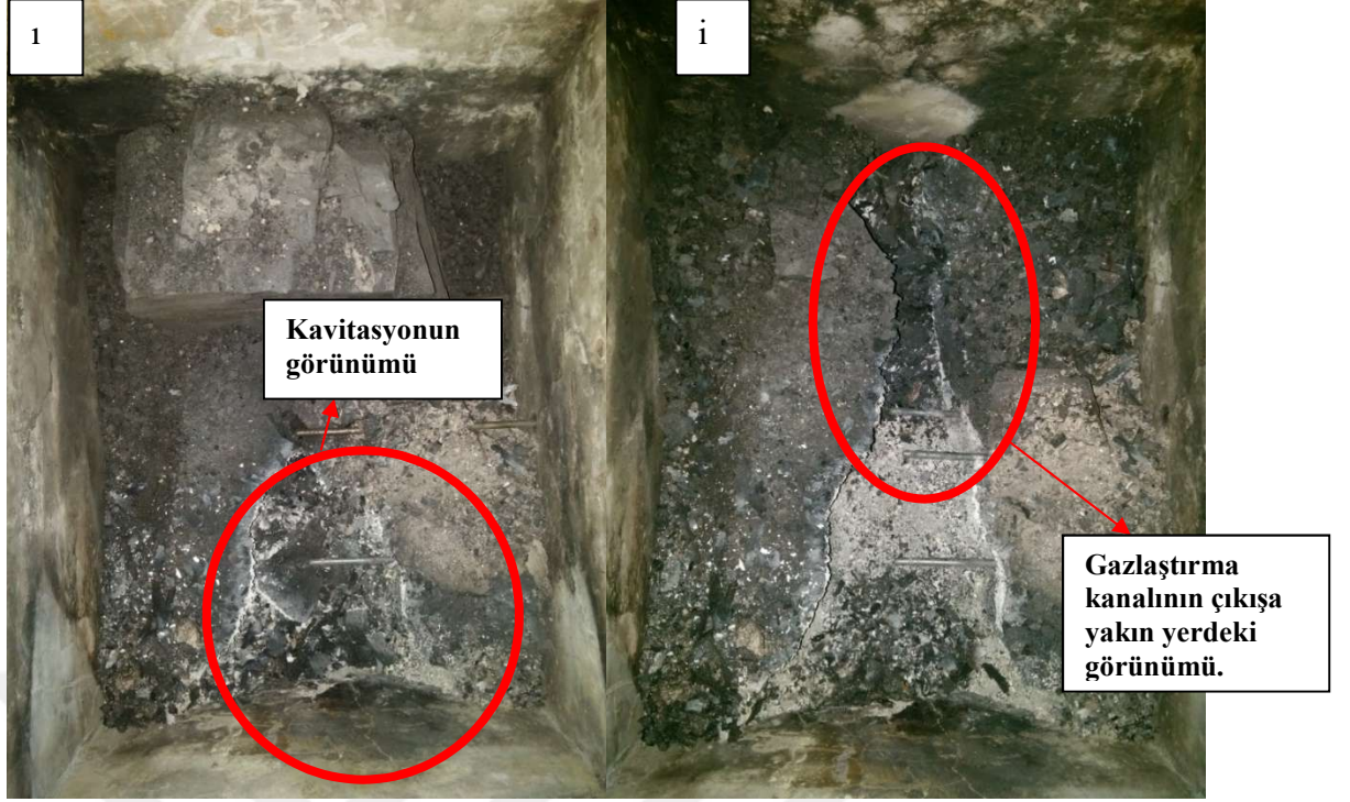
Şekil 5.7: a) Deney sonrası refrakter tuğla ve taş yününün kaldırılmış haldeki numunenin görünümü. b) Giriş bölümündeki çökmenin yakından görünümü ve Tr3. c) Oluşan kavitasyonun girişten görünümü ve Tr3,Tr7,Tr30. d) Çıkarılacak parçanın konumu. e) Parçanın çıkarılmış haldeki görünümü ve kavitasyonun varlığı. f) Tr4'ün görünümü. g) Numunenin 3 boyutlu görünümü. h) Kavitasyonun görünümü. ı) Kavitasyonun görünümü. i) Gazlaştırma kanalının çıkış bölümüne yakın yerdeki görünümü.
