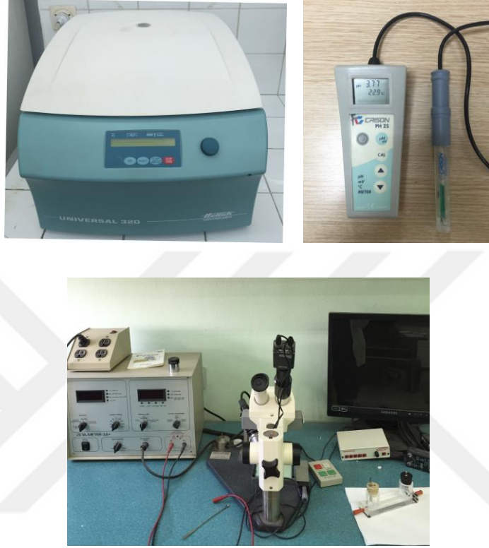
Şekil 8.31 : Zeta potansiyeli ölçümünde kullanılan a: Hettich marka santrifüj, b: Crison marka pH metre ve c: Zeta-Meter 3.0+ marka zeta metre cihazı.
