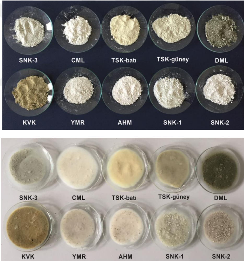
Şekil 8.1 : İslambeyli ve Pınarhisar Formasyonları (Edirne-Lalapaşa Alanı)'na ait teknolojik amaçlı seçilmiş bentonit örneklerinin öğütülmüş kuru (üstte) ve ıslak (altta) görünüşleri.
