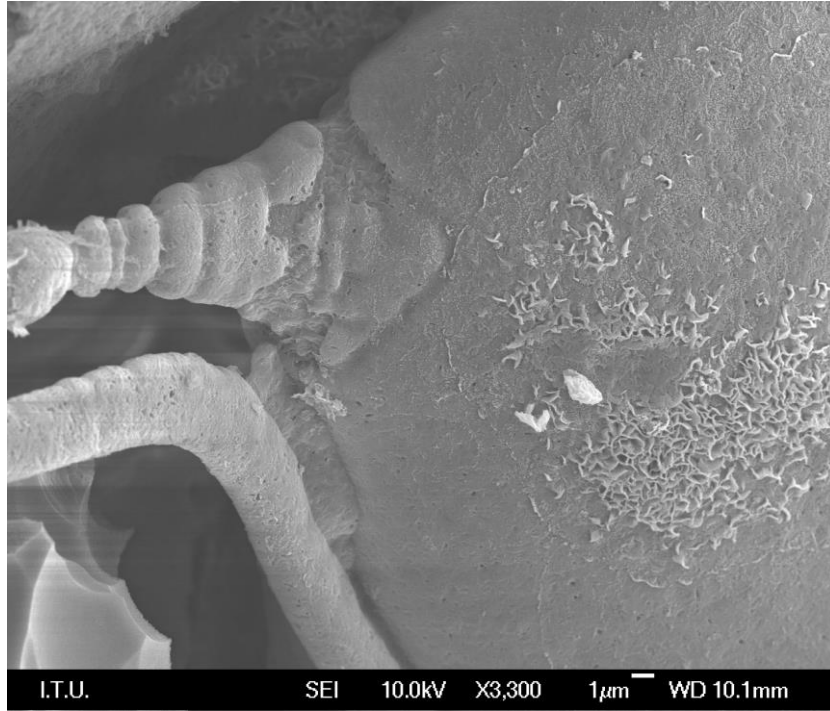
Şekil 9.5 : İslambeyli Formasyonu çökellerinde fosil tanesi üzerinde çözeltiden çökeltme ile oluşan smektit oluşumu (Edirne-Lalapaşa Alanı, Sinanköy mevki, S-31 kodlu örnek).
