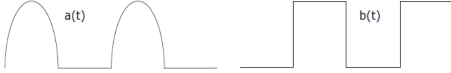
Şekil 2.19 : Kuvvetlendirici çıkışında beklenen ideal gerilim ve/veya akım dalga şekilleri (Colantonio ve diğ, 2009).
