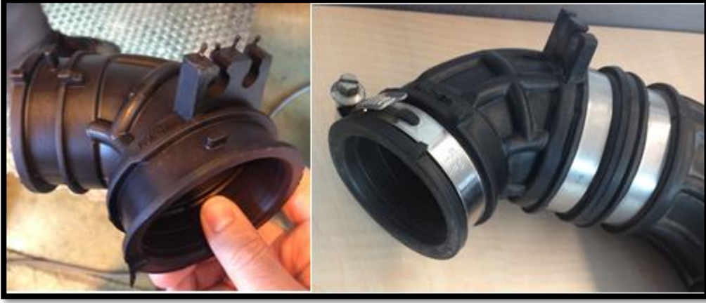
Şekil 2.27 : Kauçuk enjeksiyon çapak temizleme ve montaj.
