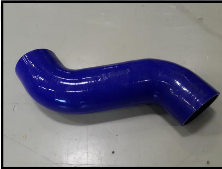
Şekil 2.11 : Ağır ticari araçlarda kullanılan bir yüksek basınç soğuk taraf hortumu.
