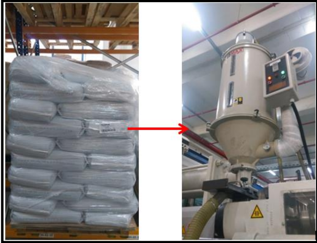
Şekil 2.17 : Plastik enjeksiyon yöntemi malzeme hazırlama.
