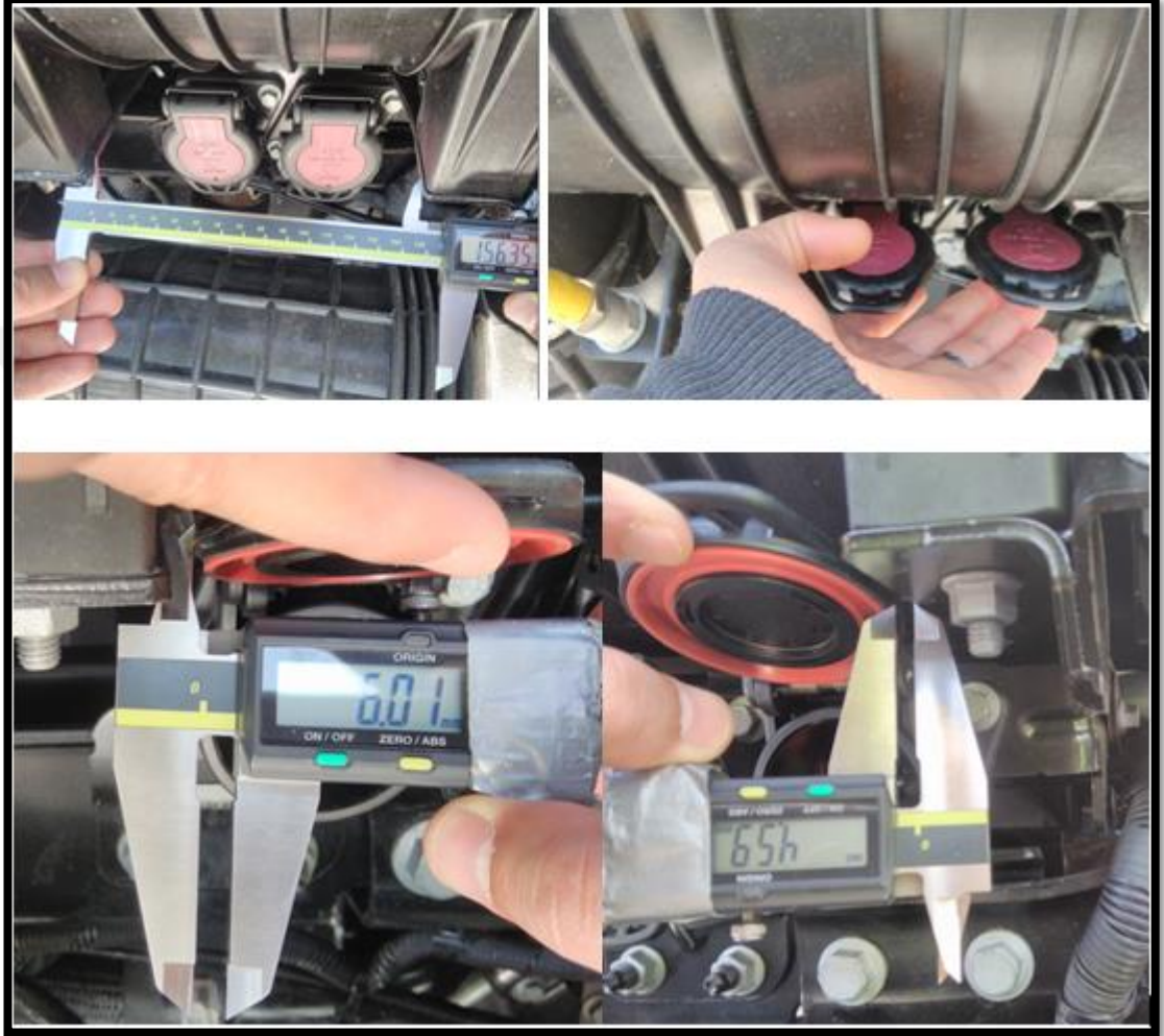
Şekil 4.21 : İlk araçta braketlerin ayakları arasındaki mesafe, soket kapakları braket ayakları arasındaki mesafe ve kapakların açılması.
