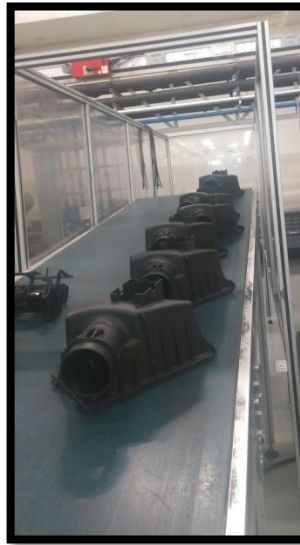
Şekil 2.22 : Plastik enjeksiyondan elde edilmiş parçaların hattan inmesi.
