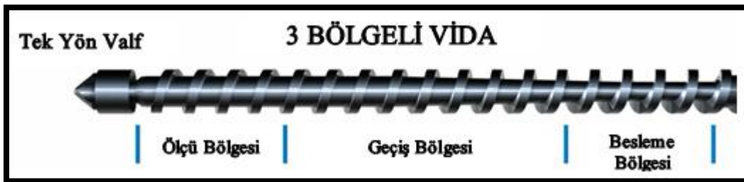
Şekil 2.19 : Plastik enjeksiyon itici kısmının bölümleri.
