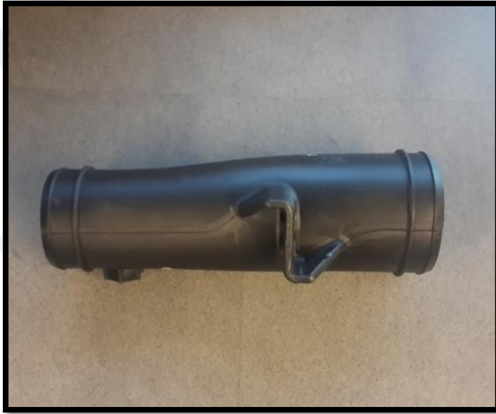
Şekil 2.9 : Ağır ticari araçlarda kullanılan bir düşük basınç borusu.
