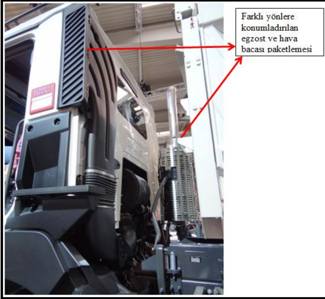
Şekil 2.6 : Ağır ticari araçlarda farklı taraflara konumlanmış hava bacası ve egzost örneği.
