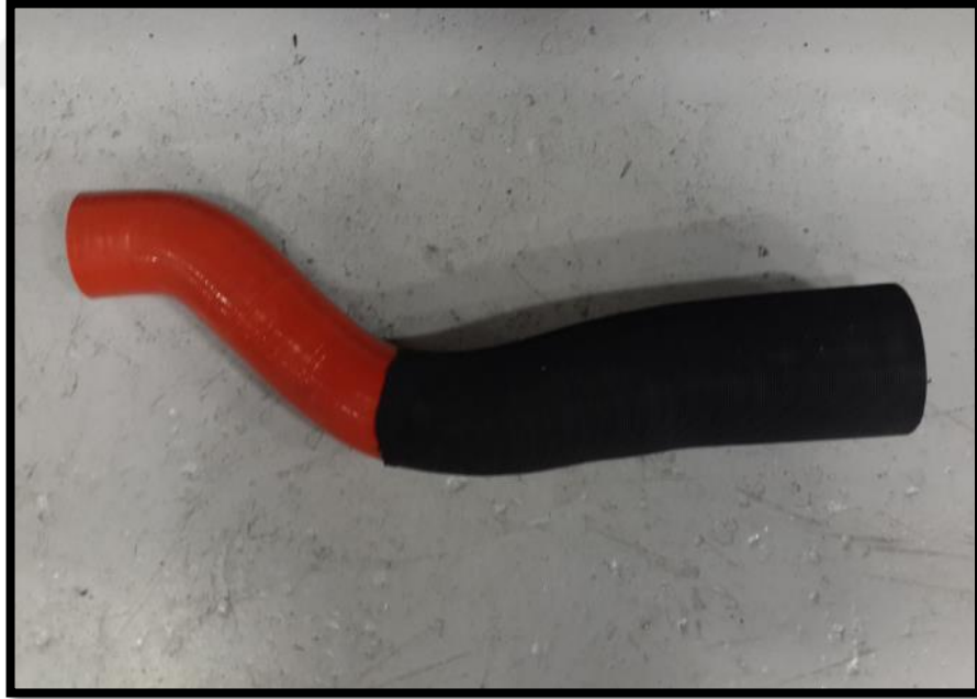
Şekil 2.10 : Ağır ticari araçlarda kullanılan bir yüksek basınç sıcak taraf hortumu.
