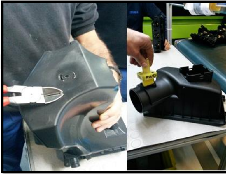
Şekil 2.23 : Plastik enjeksiyondan elde edilmiş parçaların temizlenmesi ve kontrolü.
