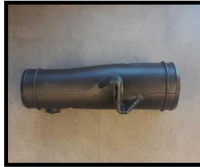
Şekil 2.3 : Ağır ticari araçlarda kullanılan plastik bir boru.
