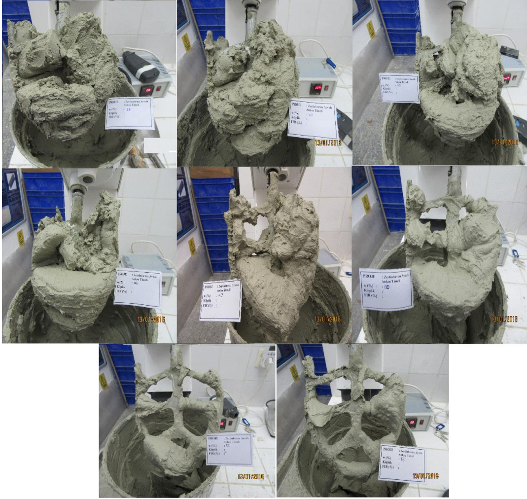
Şekil 5.66: Farklı su içeriklerinde zeminin mikser bıçağına yapışma görüntüsü (Ayvalı 2).
