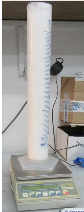
Şekil 4.13: Köpük yoğunluğu deneyi.
