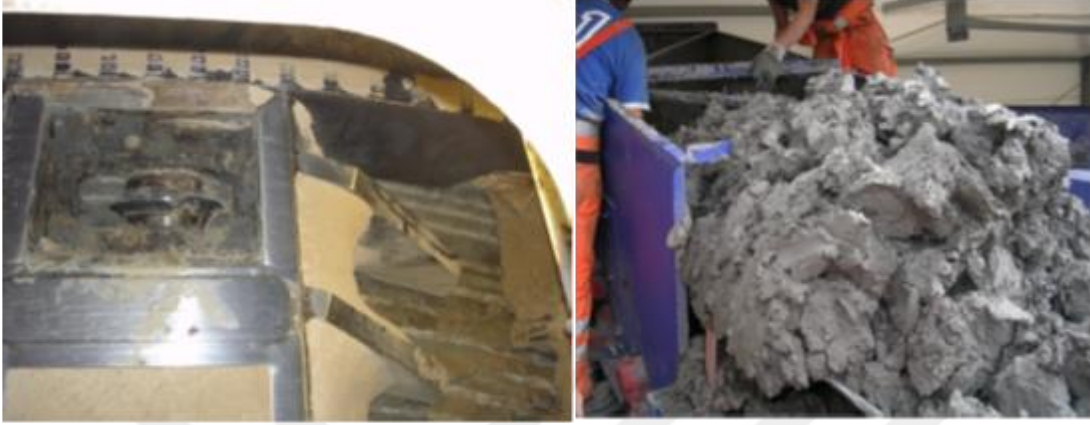
Şekil 2.20: Kesici kafa ve bantta adezyona bağlı tıkanma.
