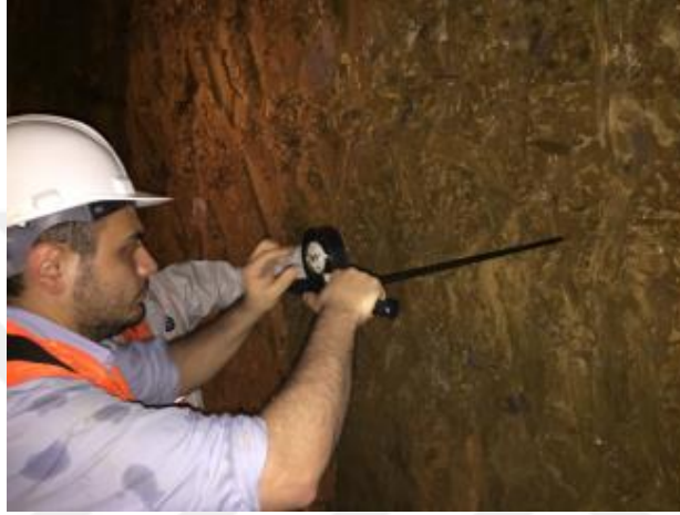
Şekil 4.9: Statik konik penetrometre deneyi.
