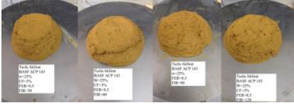
Şekil 5.84: ACP 143 ile yapılan yayılma tablası deney fotoğrafları (Akfırat).
