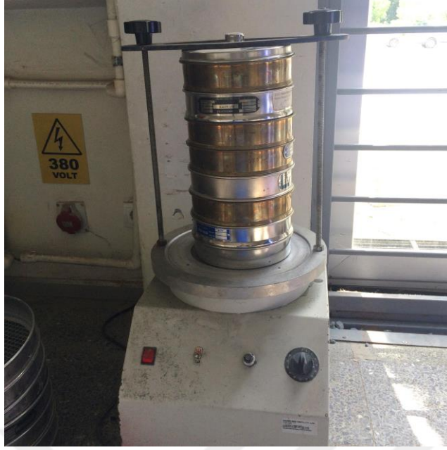
Şekil 4.3: Eleme cihazındaki elek seti.
