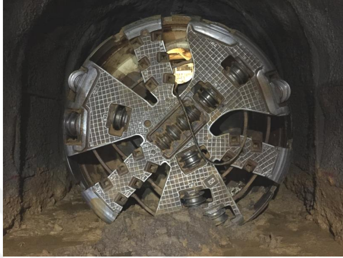
Şekil 3.5: Tuzla Akfırat Atıksu Tüneli'nde kullanılan EPB TBM.
