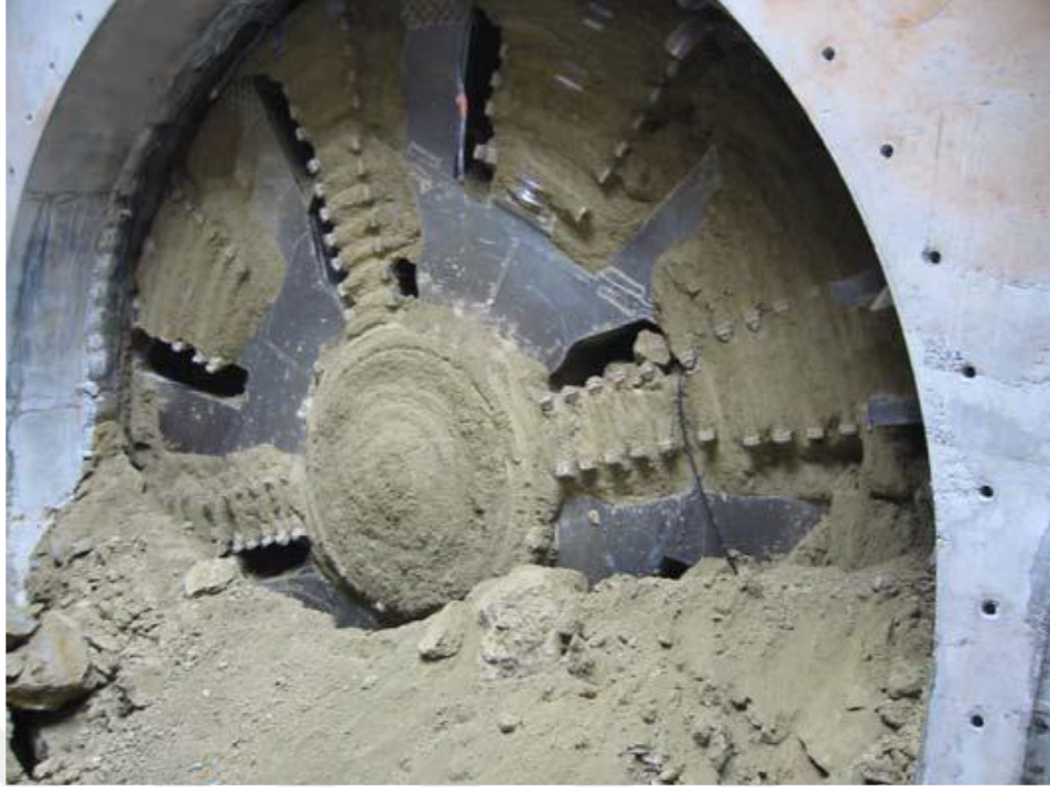
Şekil 2.18: Kesici kafayı kil sarması (Martinotto ve Langmaack, 2007).
