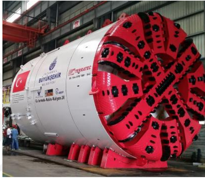
Şekil 3.7: Mecidiyeköy-Mahmutbey Metro Tüneli'nde kullanılan EPB TBM.
