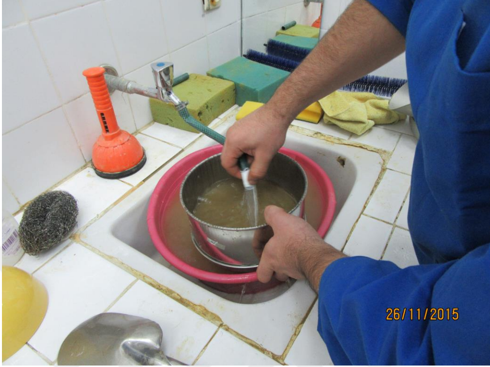
Şekil 4.2: Numunelerin yıkama eleğinde yıkanması.
