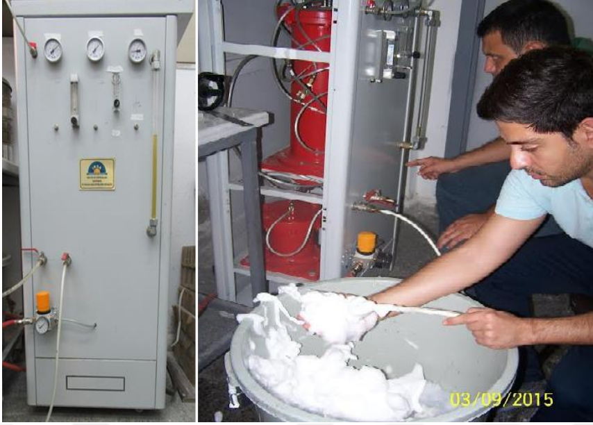
Şekil 4.12: Laboratuvar tipi köpük jeneratörü, İTÜ Maden Müh. Bölümü.
