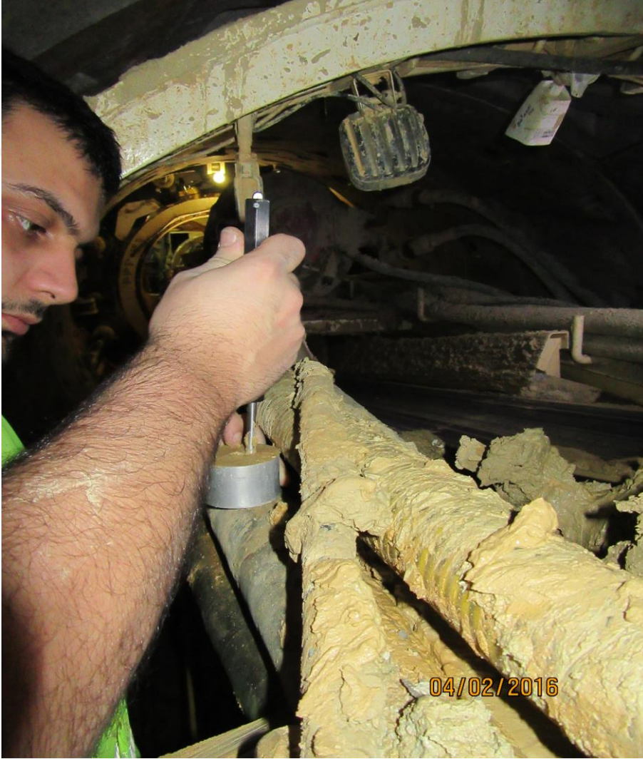
Şekil 4.19: Cep tipi penetromenin sahada kullanımı.
