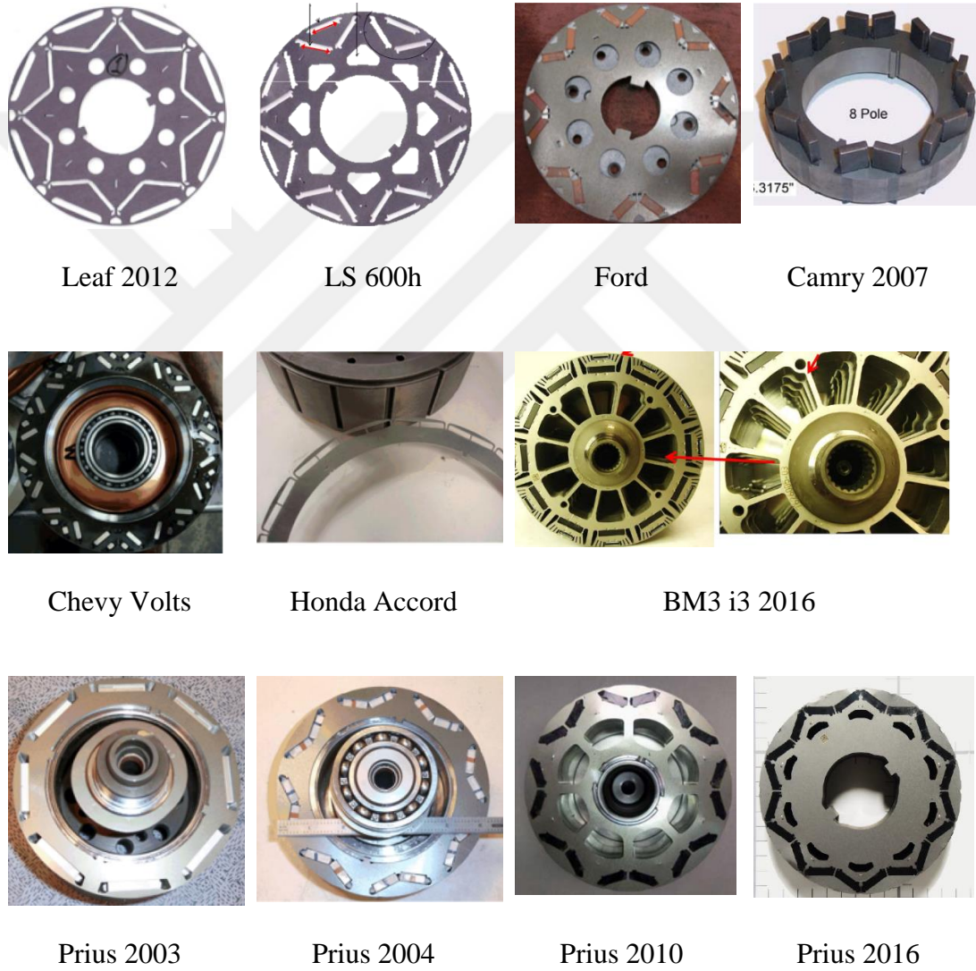
Şekil 4 : Marka, model ve yıla göre elektrikli ve hibrit otomobillerin rotor laminasyonları [53, 54, 55, 56, 57]
