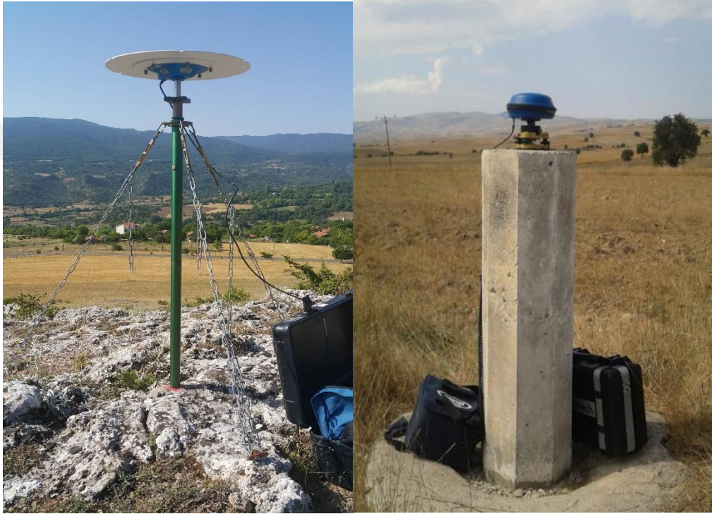
Şekil 3.4 : Proje kapsamında bronz olarak tesis edilen yer noktalarında yapılan ölçümlerde kullanılan GPS jalonu (GPS mast) ve pilye.
