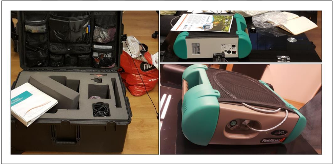
Şekil 3.14 : Tez çalışmasında 2016 yılında alınan spektral örneklerin ölçme ve değerlendirilmesi için kullanılan FieldSpec4 spektroyometresi ve aparatları.
