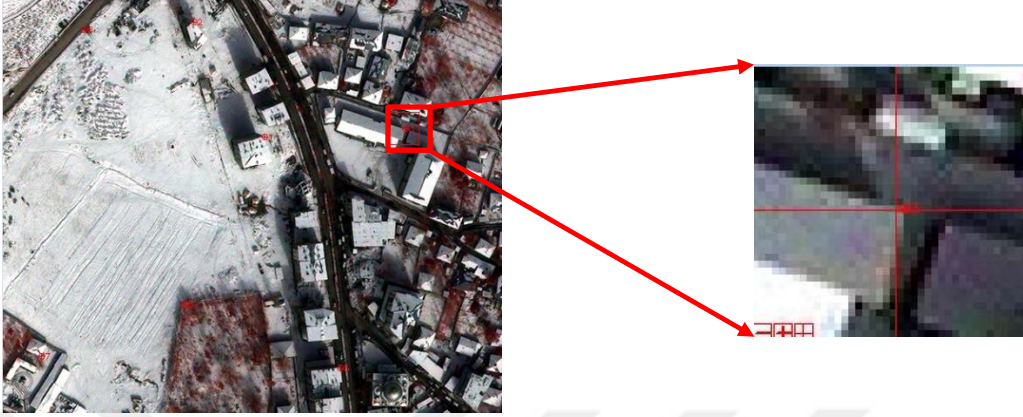
Şekil 3.10 : Geometrik düzeltmede kullanılan örnek yer kontrol noktası.
