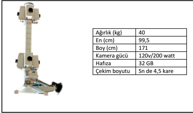
Şekil 5.3: Earthmine programında kullanılan kameranın özellikleri.
