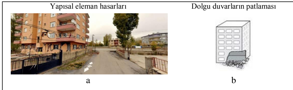
Şekil 2.12: Yapısal eleman hasarları. (a) Van-Erciş depremi sonrası yapısal eleman hasarlı bina örneği. (b) Yapısal eleman hasarına bağlı dolgu duvarlarının patlaması.
