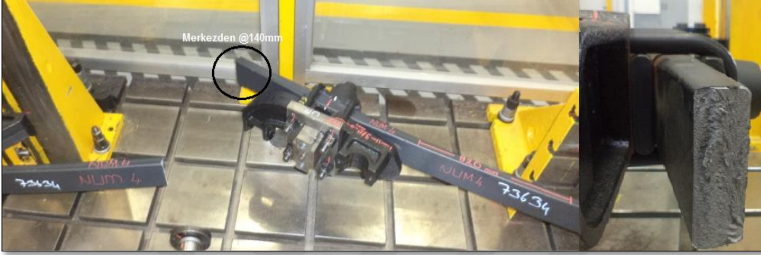
Şekil 6.17: Laboratuvar deneyinde merkezden 140 mm uzaklıktaki kat kırılması.
