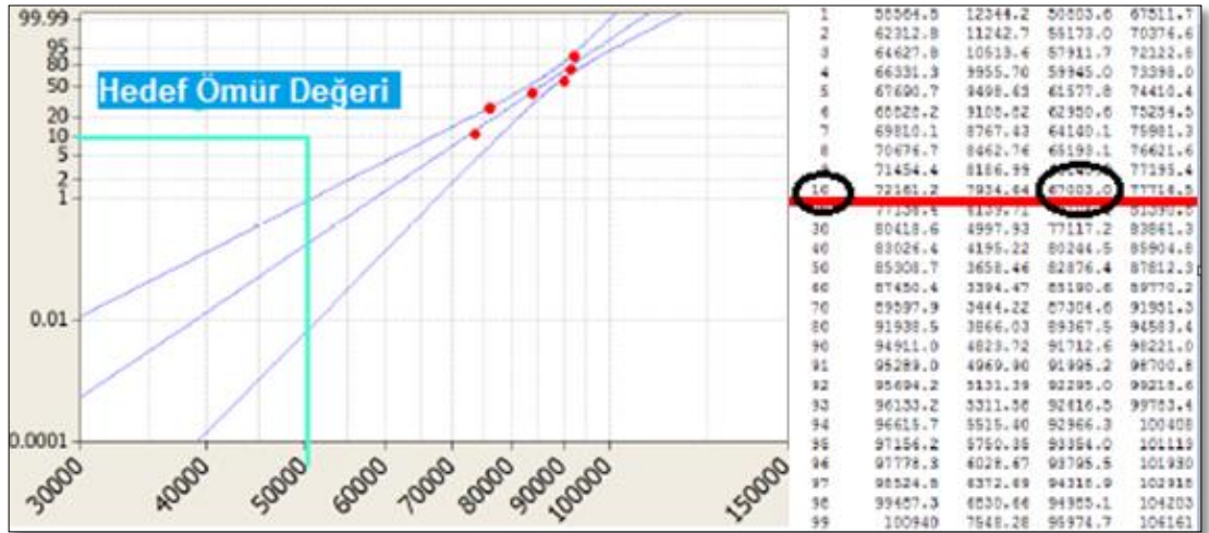
Şekil 6.16: Yaprak yayın istatistiksel dağılımı ve B10 sonucu.
