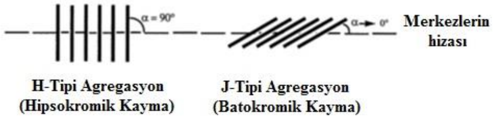
Şekil 2.7 : H-tipi ve J-tipi agregasyon oluşumunun gösterimi.
