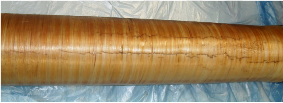
Şekil 3.5 : G otopsisine ait membranın yapısında görülen bozukluk.
