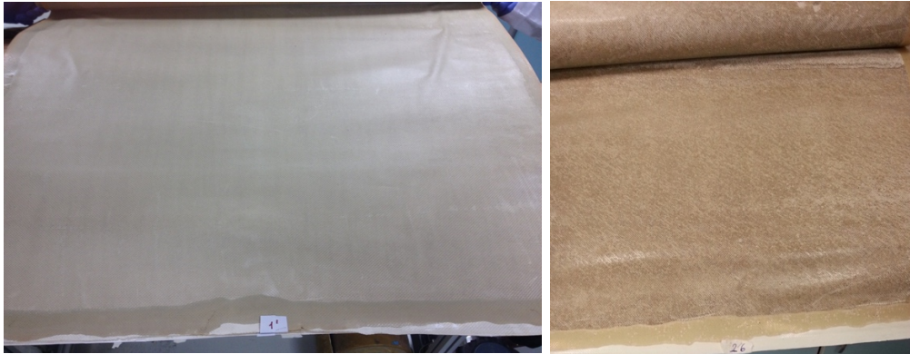
Şekil 3.12 : Ağırlıklı silisyum kirlenmiş yüzey (sol) silisyum ve demir kirliliği beraber bulunan yüzey (sağ).
