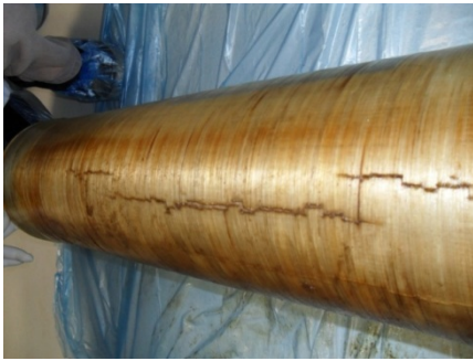
Şekil 3.6 : J otopsisine ait membranın yapısında görülen bozukluk.
