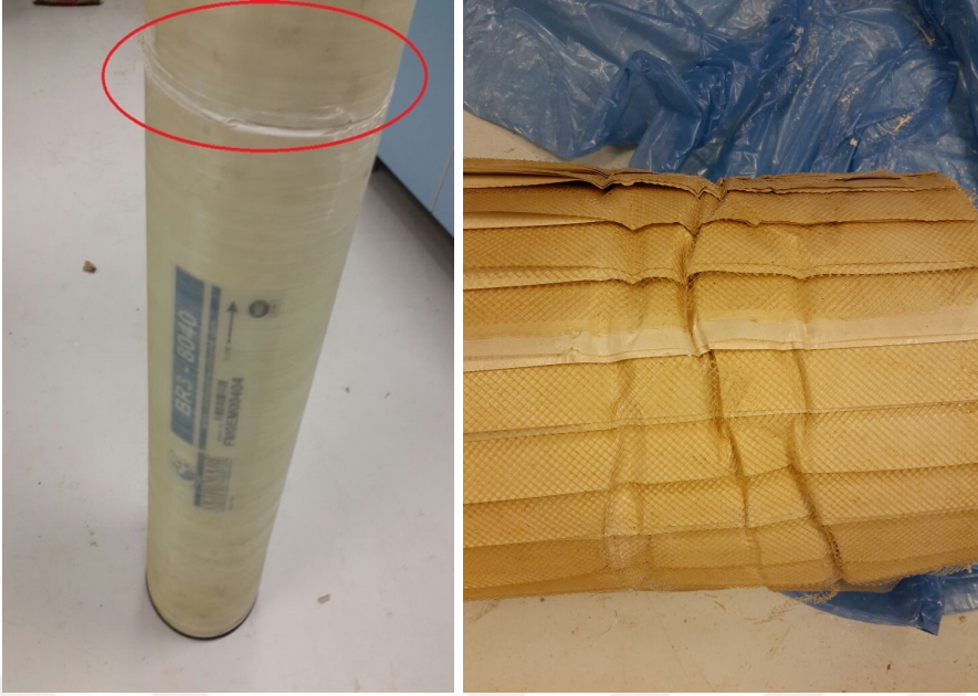
Şekil 3.5 : G otopsisine ait membranın yapısında görülen bozukluk.
