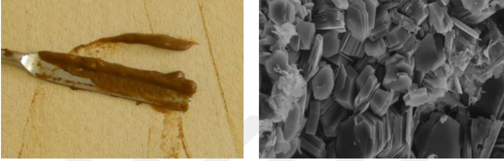
Şekil 2.4 : Membran üzerindeki kil kirlenmesi (solda) ve tetrahedron kil halkaları [5].
