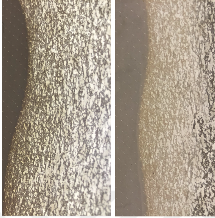
Şekil 3.9 : Yapıştırma yerlerinin kuru (solda) ve ıslak (sağda) halleri.
