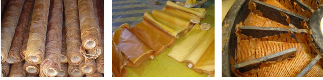
Şekil 2.2 : Soldan sağa sırayla; demir ile tıkanmış kartuş filtre, demir ile tıkanmış membran [5].
