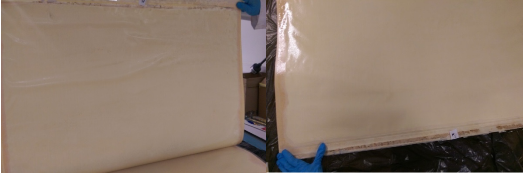
Şekil 3.13 : Ağır olarak alüminyum ile kirlenmiş bir membran görüntüsü.
