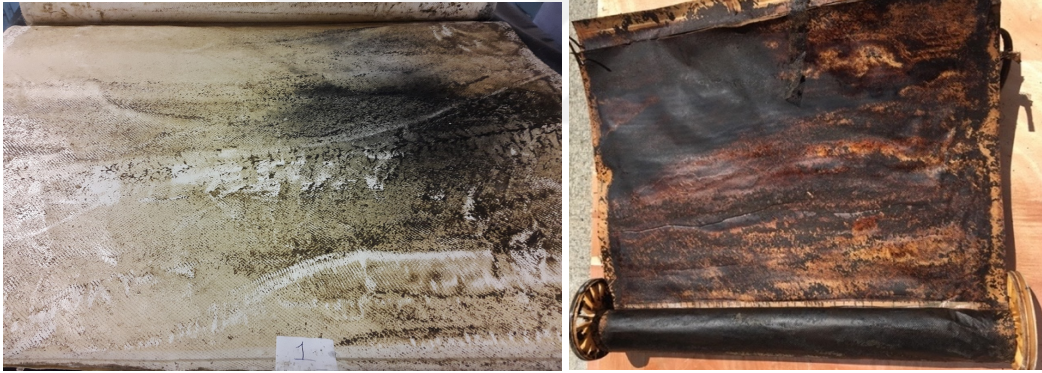
Şekil 3.14 : Sol tarafta su geri kazanımında kullanılan sağ tarafta ise sızıntı suyu arıtımında kullanılan bir membran görüntüsü.
