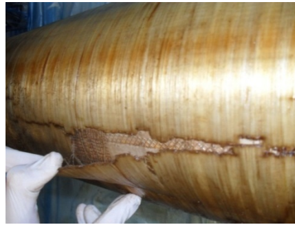
Şekil 3.6 : J otopsisine ait membranın yapısında görülen bozukluk.
