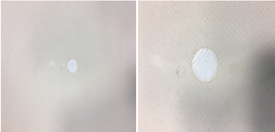
Şekil 3.10 : D otopsisinden elde edilen modül içerisindeki defolu ve yamalı bölge.
