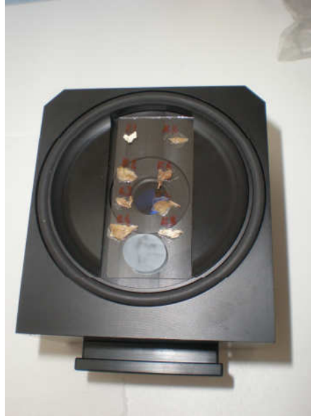
Şekil 3-5: Örneklerin LA-ICP-MS cihazına yerleştirilmesi
