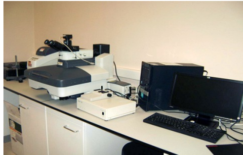
Şekil 32. Kapalı sistem Raman spektrometresi.
