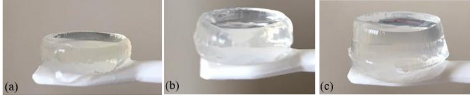
Şekil 4.4 : Oda sıcaklığı ortamında C10-PC kodlu filmin a) 1. saat, b) 2. saat, c) 3. saat şişme davranışı.
