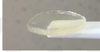
Şekil 4.6 : 37 °C ortamında C10-PC kodlu filmin 3. saat şişme davranışı.
