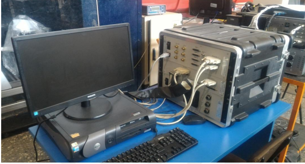
Şekil 3.16 : Kanat üzerindeki basınç ölçümlerinin yapıldığı 32 kanallı ESP-32HD minyatür basınç tarayıcı ve Aeroprobe yazılımının kullanıldığı bilgisayar.
