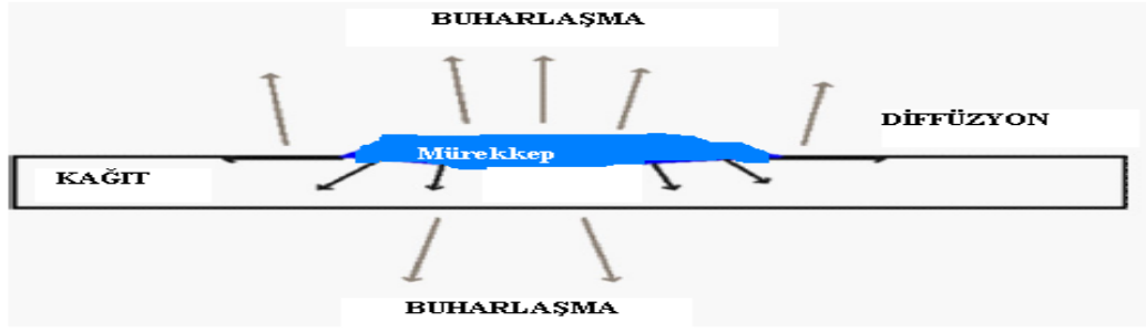
Şekil 2.8: Kağıt üzerinde eş zamanlı olarak gerçekleşen mürekkebin kuruma süreci
