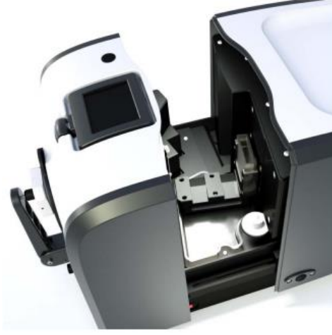
Şekil 4.5 : Datacolor SF850 spektrofotometre. a) Renk ölçüm ünitesi (Datacolor), b) Transmisyon ölçüm ünitesi (Datacolor).
