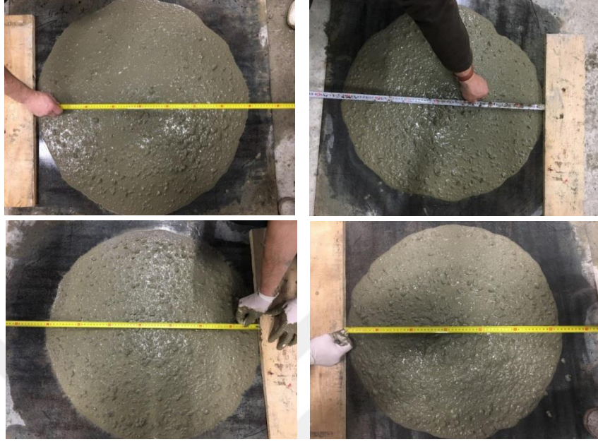
Şekil 4.1: Uçucu küllü karışımların yayılma deneyi (soldan sağa doğru doğru 350-0, 350-36, 350-72 ve 350-108 ).
