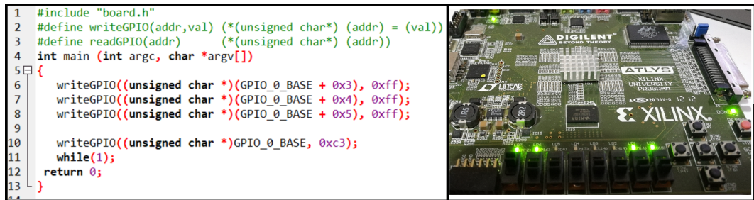
Şekil 4.1 : OpenRISC için yazılan LedTest uygulaması ve ledlerin durumu.
