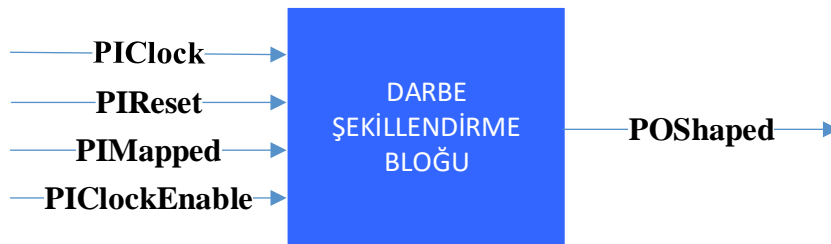
Şekil 6.38 : Darbe Şekillendirme Bloğu Giriş-Çıkış Blok Şeması.
