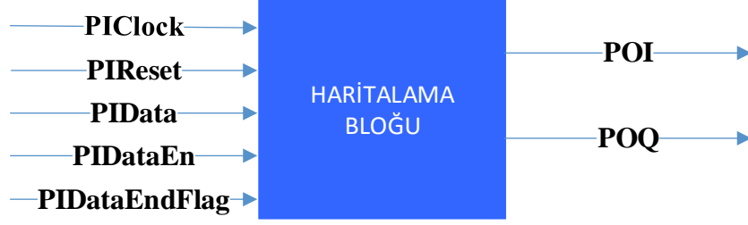
Şekil 6.21 : Haritalama Bloğu Giriş-Çıkış Blok Şeması.
