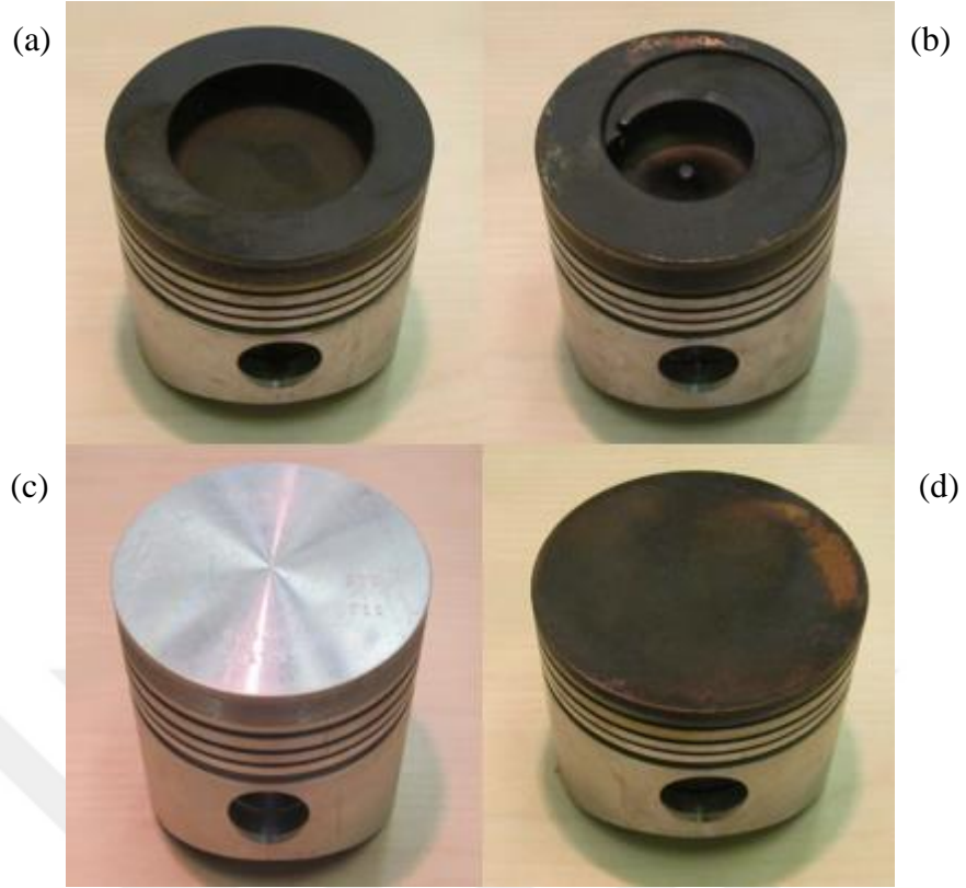
Şekil 2.11 : Deneyleerde kullanılan yanma odası geometrileri, SO (a), MR (b), İşlenmemiş (c), Düz (d).
