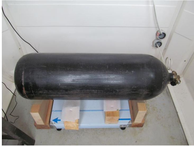
Şekil 2.8 : Kabin içerisinde terazi ve tüpün konumlandırılması.
