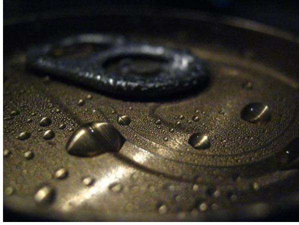
Şekil 3.3 : Alüminyum içecek kutusu üzerinde damlacık yoğuşması.
