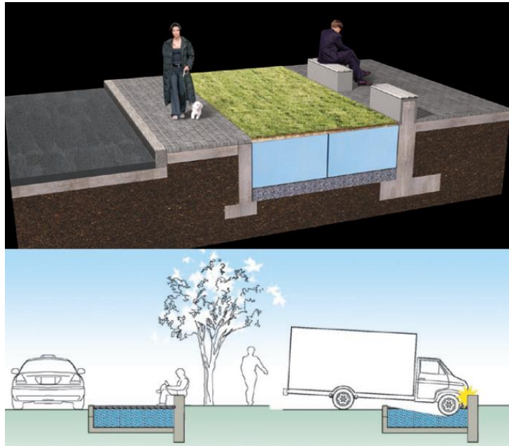
Şekil 3.22 : Kaplan tuzağı bariyer sisteminin çalışma prensipleri (FEMA, 2007).
