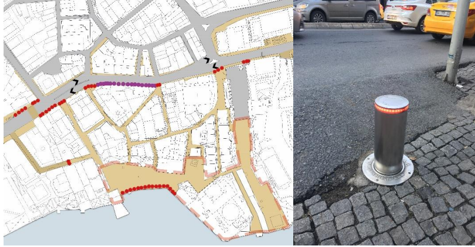
Şekil 4.46 : Ortaköy meydanında sabit ve hidrolik tipli babalar ve mantarlar.
