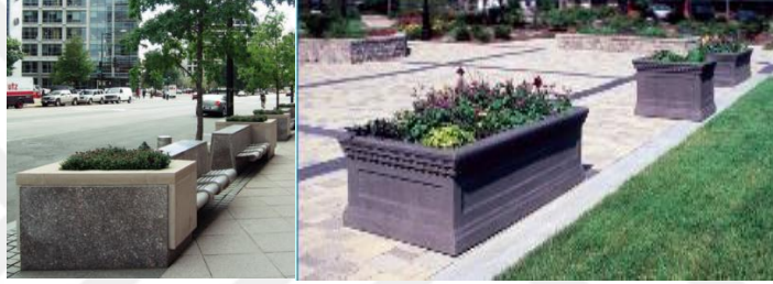
Şekil 3.12 : Araç güzergahı ve yaya güzergahı ayrışımı için bir örnek (FEMA, 2007).
