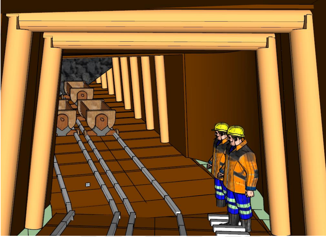
Şekil 4.6: Kancadibinde Dolu ve Boş Vagonları Ayarlayan 2 İşçi [21]
