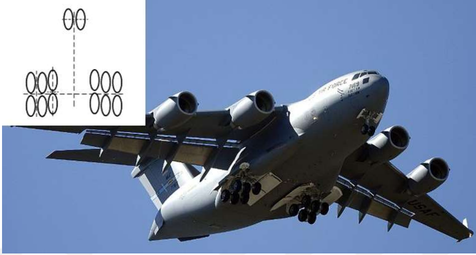
Şekil 2.7 : Art arda konumlandırılmış iki üçlü tekerden oluşan ana iniş takımı ve iki tekerden oluşan burun iniş takımı (2T- Two Triple wheels in Tandem Main Gear with Dual Wheel Nose Gear) Boeing C-17 [18].
