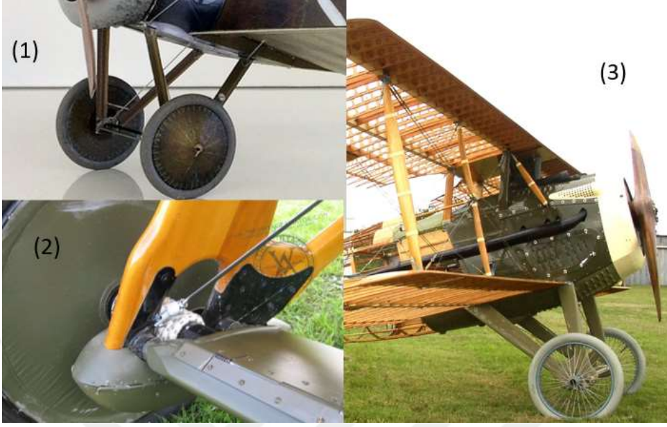
Şekil 2.2 : Birinci Dünya Savaşı sırasında kullanılan üç farklı uçağa ait üç iniş takımı amortisörü 1) Sopwith Camel 2)Royal Aircraft-Factory S.E.5 3) SPAD S.VIII [11,12,13].
