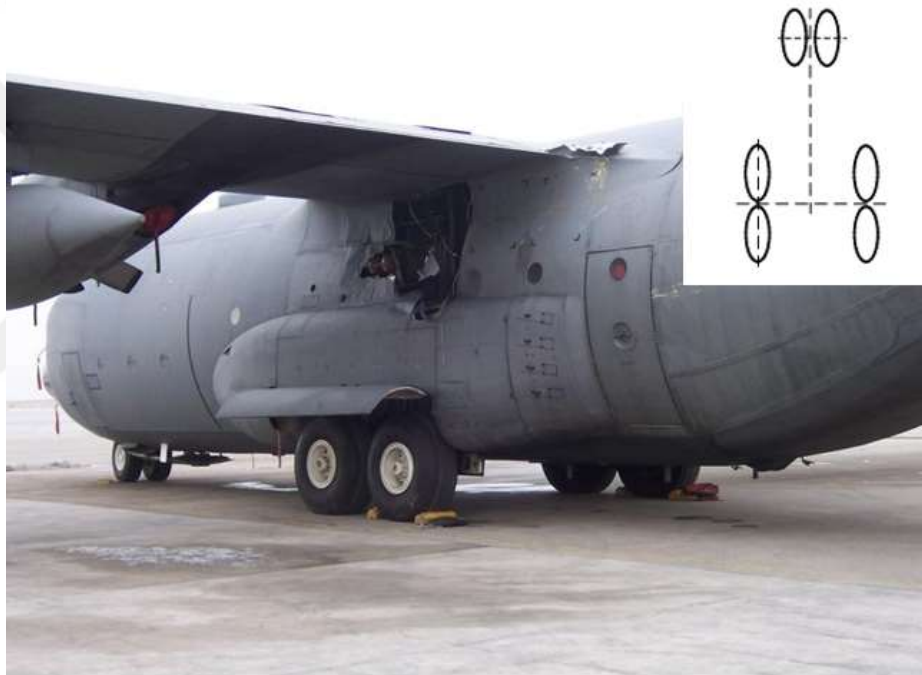
Şekil 2.6 : Art arda konumlandırılmış iki tekli tekerlerden oluşan ana iniş takımı ve ikili tekerden oluşan burun iniş takımı (2S-Two Single Wheels in Tandem Main Gear with Dual Wheel Nose Gear) Lockheed C-130 [17].
