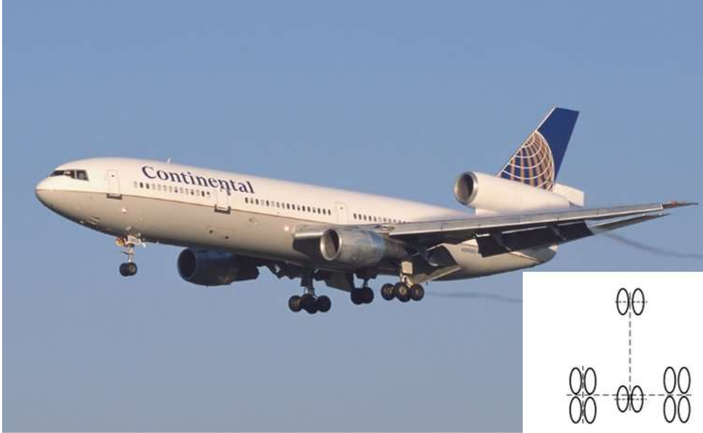
Şekil 2.8 : Art arda konumlandırılmış iki ikili tekerden oluşan, bir tane de ikili gövde tekerinden oluşan ana iniş takımı ve iki tekerden oluşan burun iniş takımı (2D/D1 Two Dual Wheels in Tandem Main Gear/Dual Wheel Body Gear with Dual Wheel Nose Gear) McDonnell Douglas DC-10 [19].
