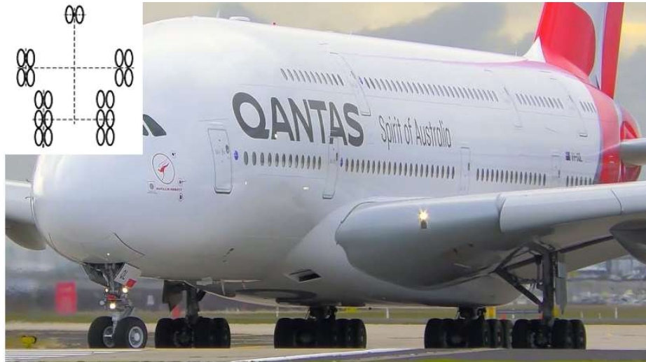
Şekil 2.10 : Art arda konumlandırılmış ikili iki ana iniş takımı, yine art arda konumlandırılmış üçlü iki gövde iniş takımı ve bir çift burun iniş takımı (2D/3D2 Two Dual Wheels in Tandem Main Gear / Three Dual Wheels in Tandem Body Gear with Dual wheel Nose Gear) Airbus A380 [21].
