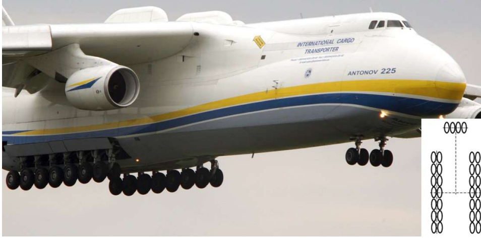
Şekil 2.11 : Art arda dizilmiş yedi ikili ana iniş takımı ve dörtlü bir burun iniş takımı (7D- Seven Dual Wheels in Tandem Main Gear with Quadruple Nose Gear) Antonov AN-225 [22].
