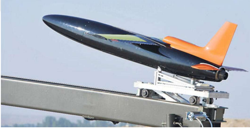
Şekil 2.20 : Şimşek hedef uçağı ve kalkış için kullanılan serbest bırakılabilir rayı [32].
