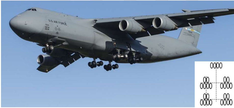
Şekil 2.12 : İkili ve dörtlü birleştirilmiş art arda konumlandırılmış iki ana iniş takımı ve dörtlü bir burun iniş takımı (C5 Complex Gear Comprised of Dual Wheel and Quadruple Wheel Combination with Quadruple Wheel Nose Gear) Lockheed C5 Galaxy [23].
