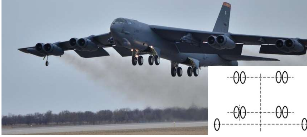
Şekil 2.13 : İki tekerli ana iniş takımı her taraf için iki dikme ve ayrıca bir burun iniş takımı bulunmamakta. (D2 Dual Wheel Gear Two Struts per Side Main Gear with No Separate Nose Gear) B52 Bomber [24].
