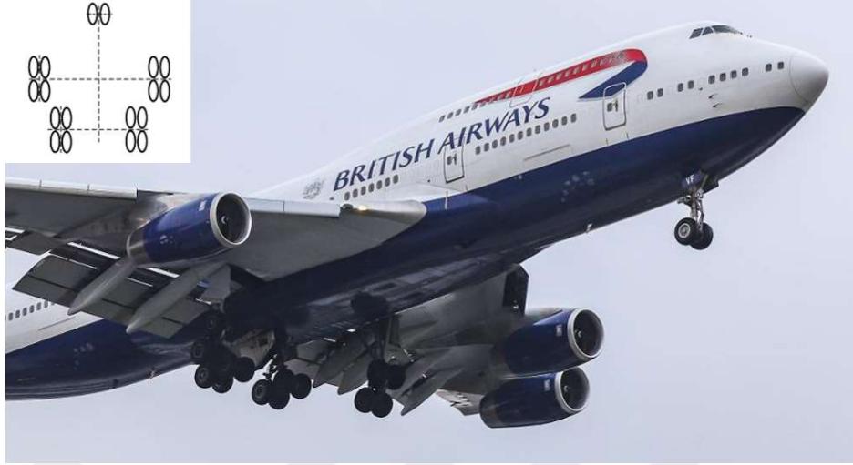
Şekil 2.9 : Art arda konumlandırılmış ikili iki ana iniş takımı ve yine aynı şekilde konumlandırılmış ikili iki gövde iniş takımı ve iki tekerli burun iniş takımı (2D/2D2 Two Dual Wheels in Tandem Main Gear / Two Dual Wheels in Tandem Body Gear with Dual Wheel Nose Gear) Boeing 747 [20].
