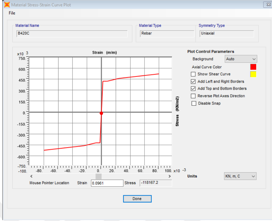
Şekil 6.10: B420C donatı çeliği için gerilme-şekildeğiştirme eğrisi.
