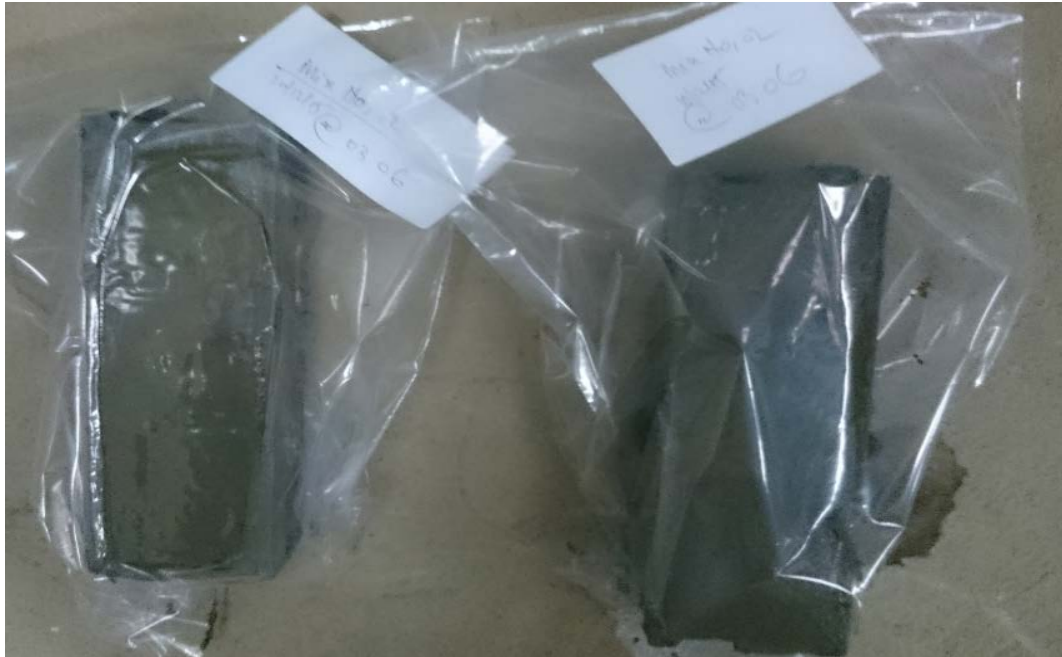
Şekil 4.22: 5x5 küp numuneleri ( 2 adet 1 günlük, 2 adet 28 günlük, 2 adet yedek).
