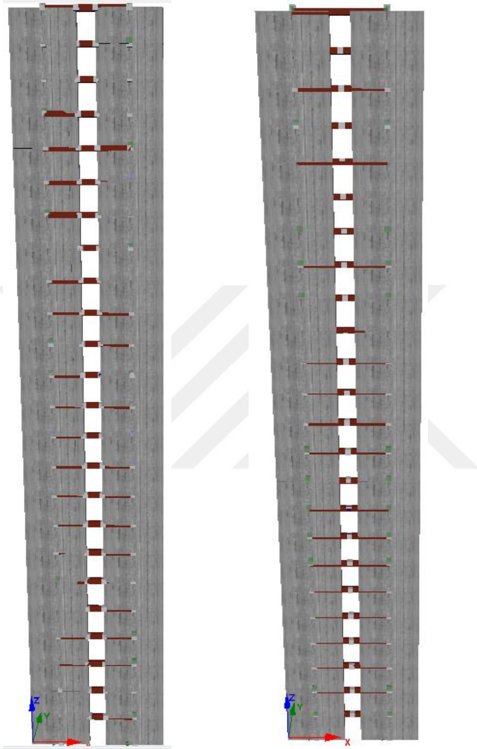
Şekil 4.22 : Mafsallı (solda) ve çelik yastıklı (sağda) modelin programdaki görüntüsü.
