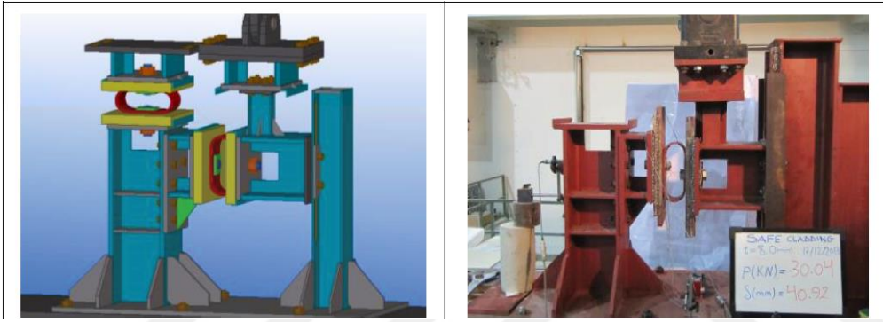
Şekil 3.2 : Aksenal (solda) ve kesme (sağda) deneylerinin genel görünüşü (Özkaynak et al., 2015).
