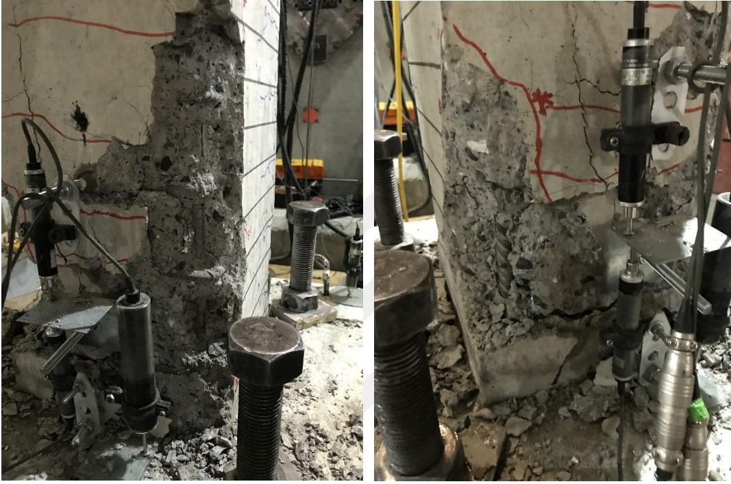
Şekil 4.23 : GDA-30M numunesi %4 öteleme oranı çekme çevrimi hasar görünümü.
