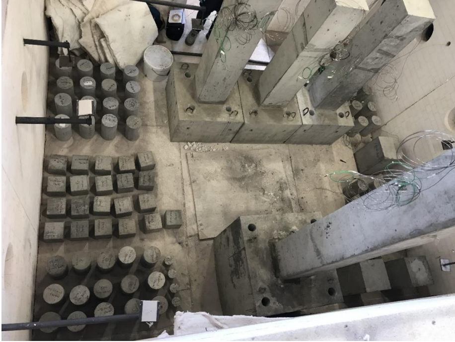
Şekil 3.7 : 60 dakikalık yangın senaryosu deneyi öncesi numunelerin fırın içi yerleşimi.
