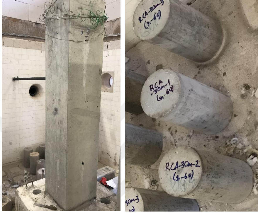
Şekil 3.5 : 30 dakikalık yangın senaryosuna maruz kalan numunelerin görünümü.
