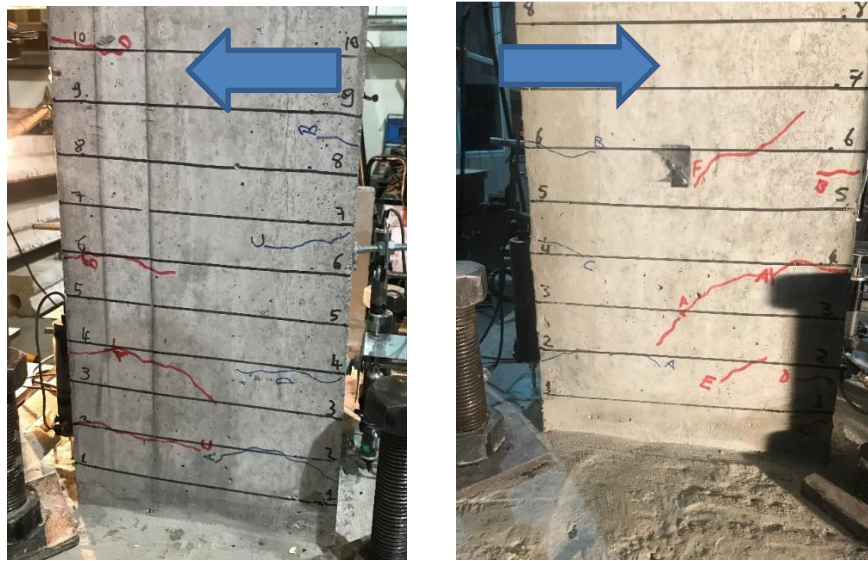
Şekil 4.4 : GDA-REF %1 öteleme oranı itme sonrası doğu (E) ve batı (W) yüzlerinde oluşan eğilme çatlakları.
