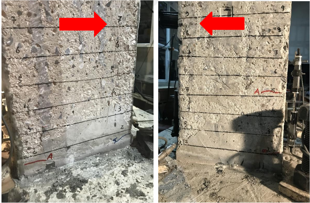
Şekil 4.59 : GDA-90M numunesi %1 öteleme oranı çekme batı (W) ve doğu (E) yüzlerinin hasar görünümü.
