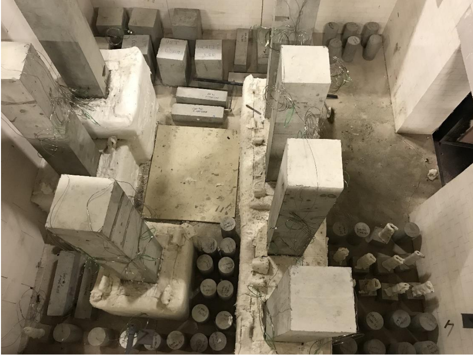
Şekil 3.10 : 90 dakika yangın senaryosu deneyi öncesi fırın içi numune yerleşimi.
