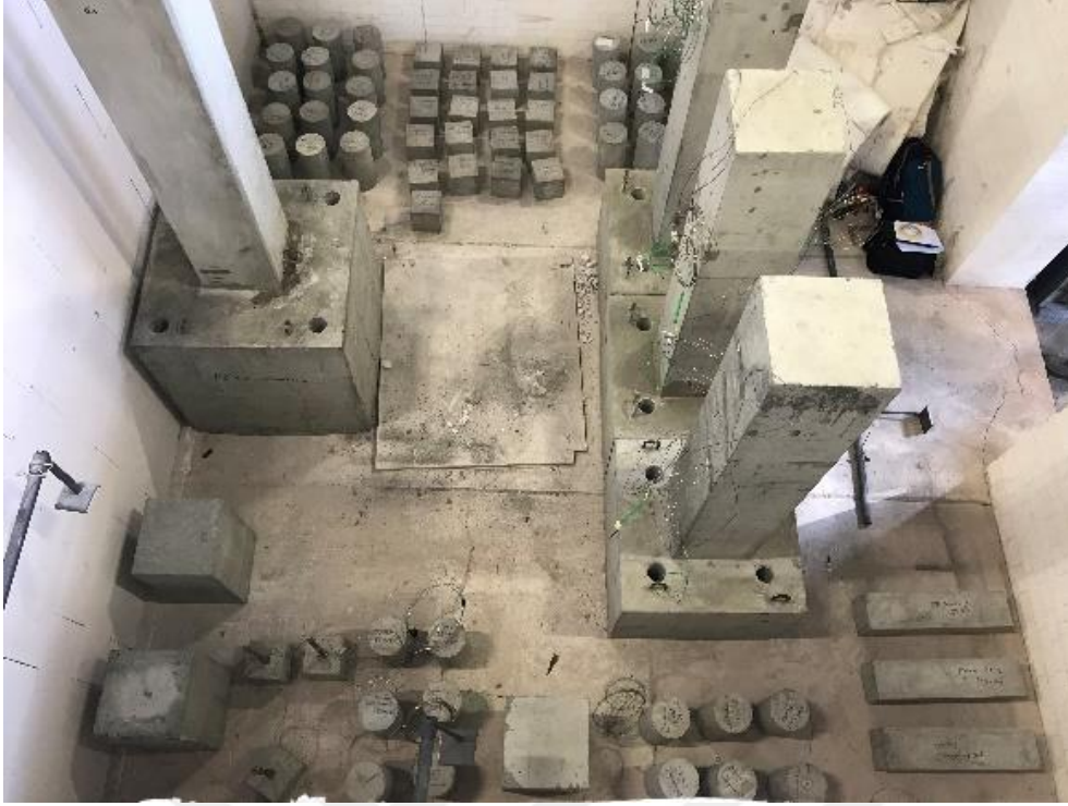
Şekil 3.3 : 30 dakikalık yangın senaryosu deneyi öncesi fırın içi numune yerleşimi.
