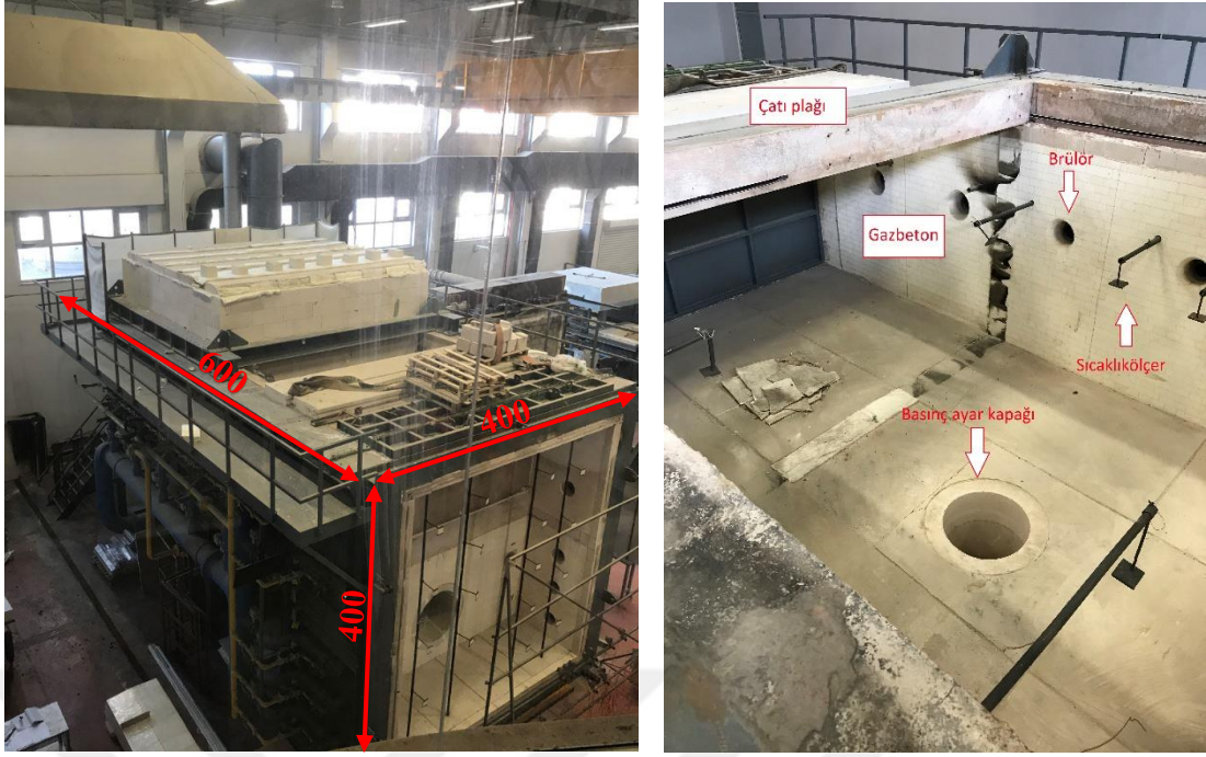
Şekil 3.2 : Fırının a) dış ve b) iç görünümü.
