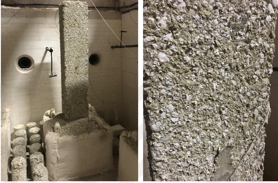
Şekil 3.11 : 90 dakikalık yangın senaryosu deneyi sonrası numune görünümüleri.
