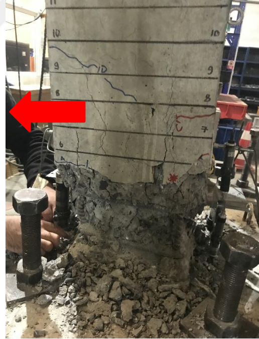
Şekil 4.25 : GDA-30M numunesi %5 öteleme oranı doğu (E) ve batı (W) yüzlerinin hasar görünümü.
