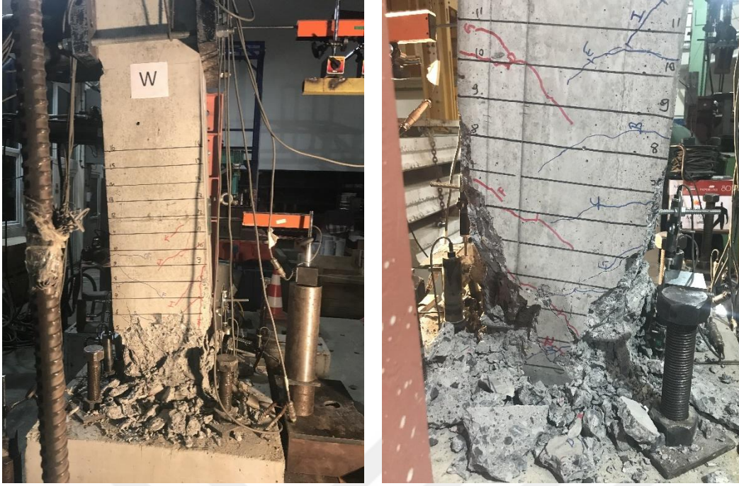
Şekil 4.11 : GDA-REF deney sonu P=0 kN iken numunenin hasar durumu.
