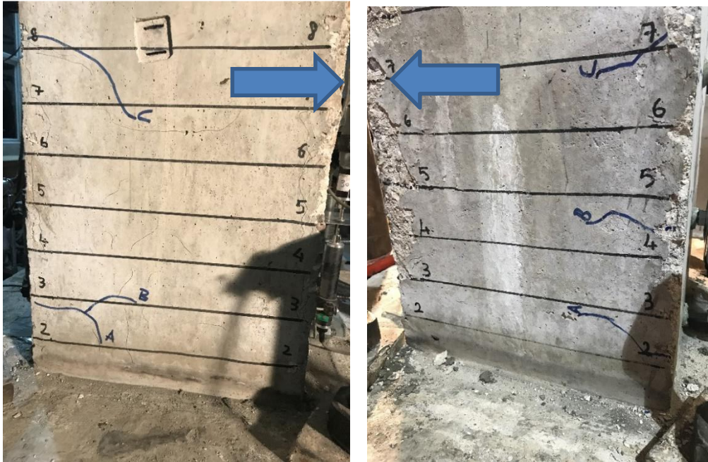
Şekil 4.38 : GDA-60M numunesi %1 öteleme oranı itme batı (W) ve doğu (E) yüzlerinin hasar görünümü.
