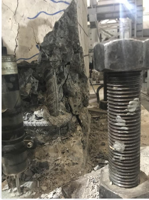
Şekil 4.24 : %5 öteleme oranı çekme sonrası kuzey (N) ve batı (W) birleşimindeki donatı burkulması.
