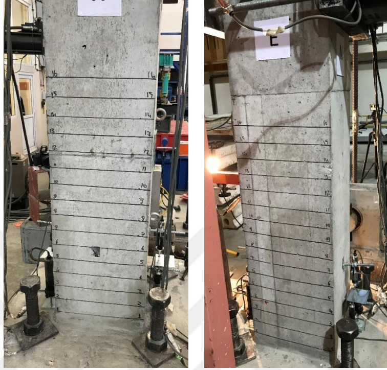
Şekil 4.3 : GDA-REF batı (W) yüzü ve doğu (E) yüzü, hasarsız ve ilk eğilme çatlakları (%0.5 öteleme oranı) oluşuktan sonraki durumu.
