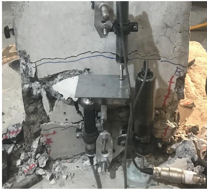
Şekil 4.7 : GDA-REF %5 öteleme oranı itme sonrası kuzey (N) yüzünde oluşan ezilme hasarı.
