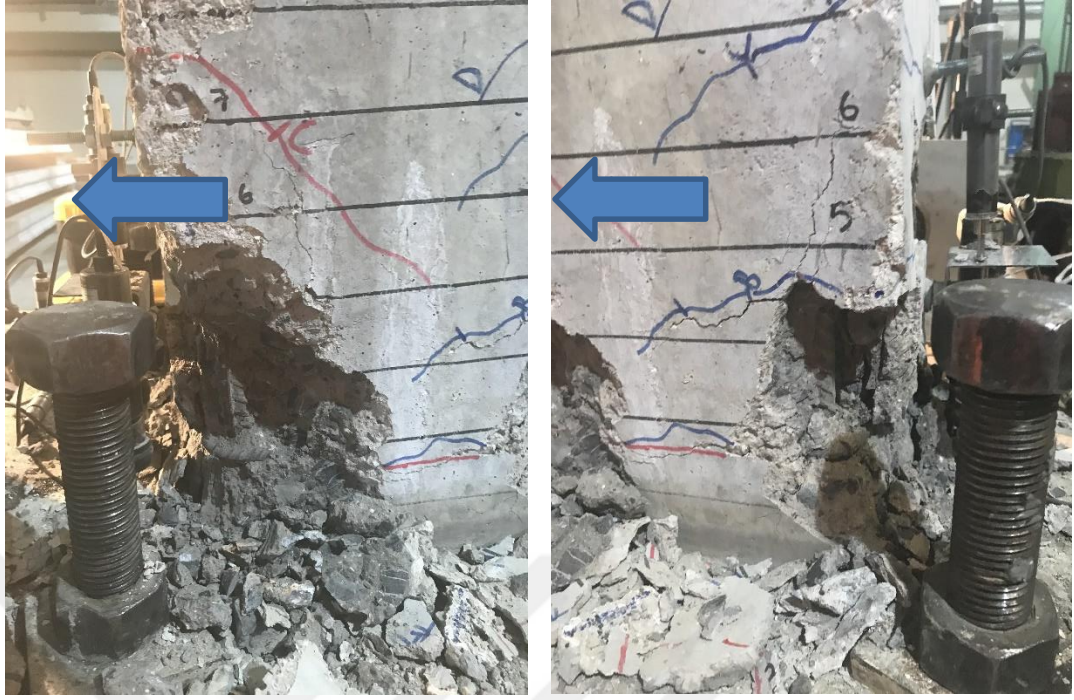
Şekil 4.43 : GDA-60M numunesi %5 öteleme oranı itme güney-doğu(S-E) ve güney-batı(N-E) köşelerindeki donatı burkulması.
