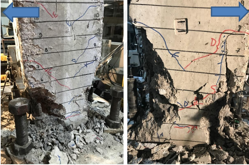
Şekil 4.45 : GDA-60M numunesi %6 öteleme oranı itme çevrimi batı (W) ve doğu (E) yüzlerindeki hasar görünümü.
