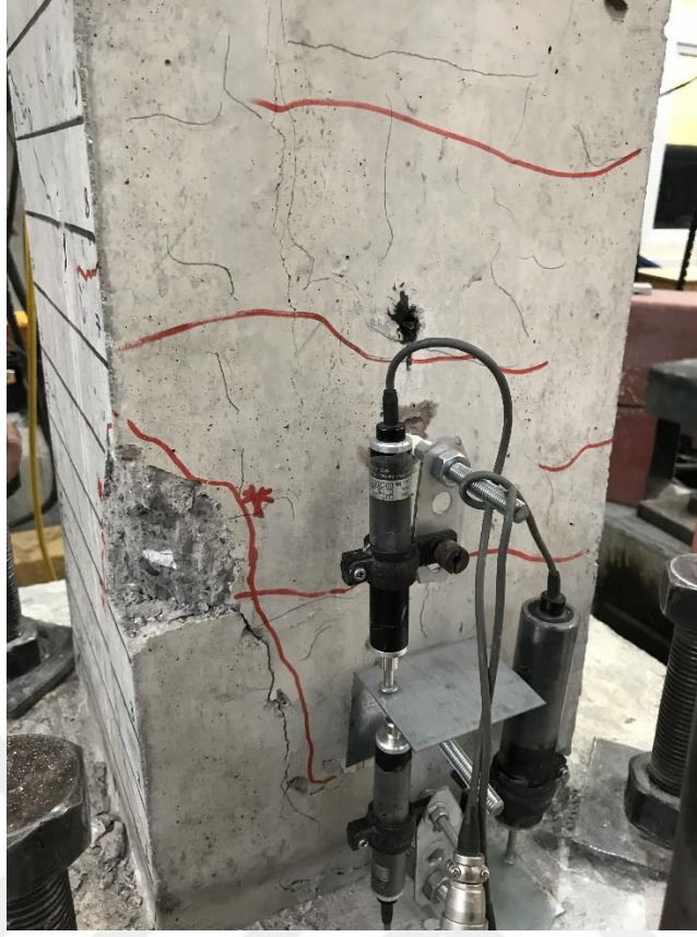
Şekil 4.21 : GDA-30M numunesi %2 öteleme oranı itme çevrimi güney (S) yüzündeki ezilme başlangıcı.
