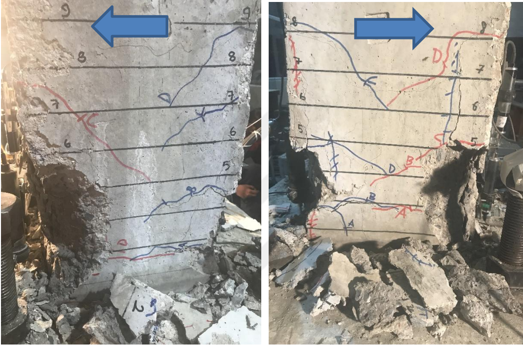
Şekil 4.42 : GDA-60M numunesi %4 öteleme oranı itme batı (W) ve doğu (E) yüzlerinin hasar görünümü.
