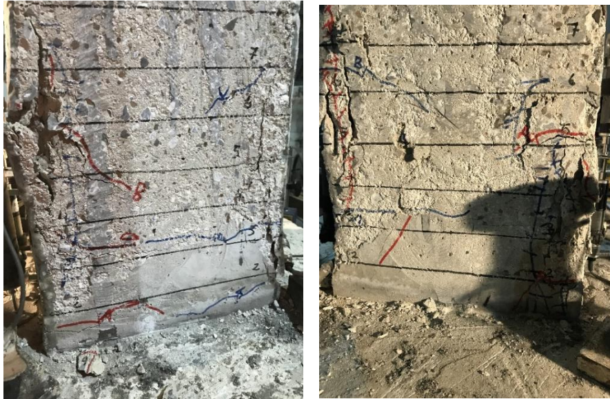
Şekil 4.63 : GDA-90M numunesi %3 öteleme oranı doğu (E) ve batı (W) yüzlerinin hasar görünümü.
