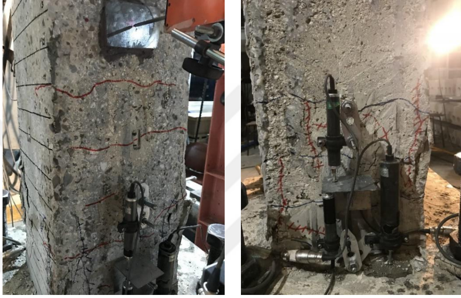
Şekil 4.62 : GDA-90M numunesi %3 öteleme oranı güney (S) ve kuzey (N) yüzlerinin hasar görünümü.
