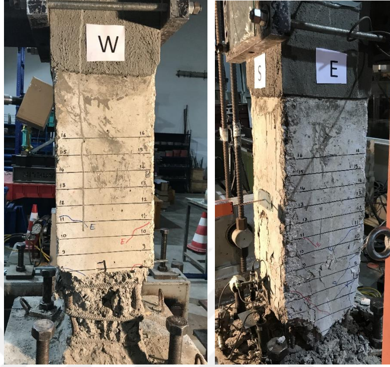
Şekil 4.49 : GDA-60M numunesi %6 öteleme oranı itme çevrimi batı (W) ve doğu (E) yüzlerindeki hasar görünümü.
