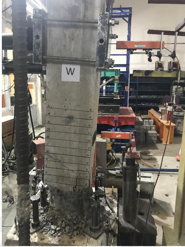
Şekil 4.27 : GDA-30M numunesi deney sonrası numunenin durumu ( P=0 , \delta=65.1 mm).
