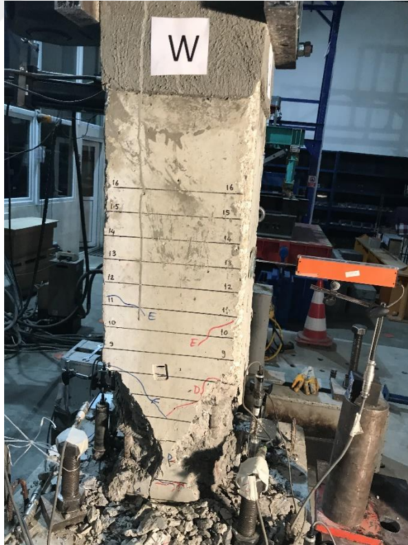
Şekil 4.47 : GDA-60M numunesi %6 öteleleme oranı yüksüz durumdaki ( P=0 kN, \delta=41.21 mm) hasar görünümü.
