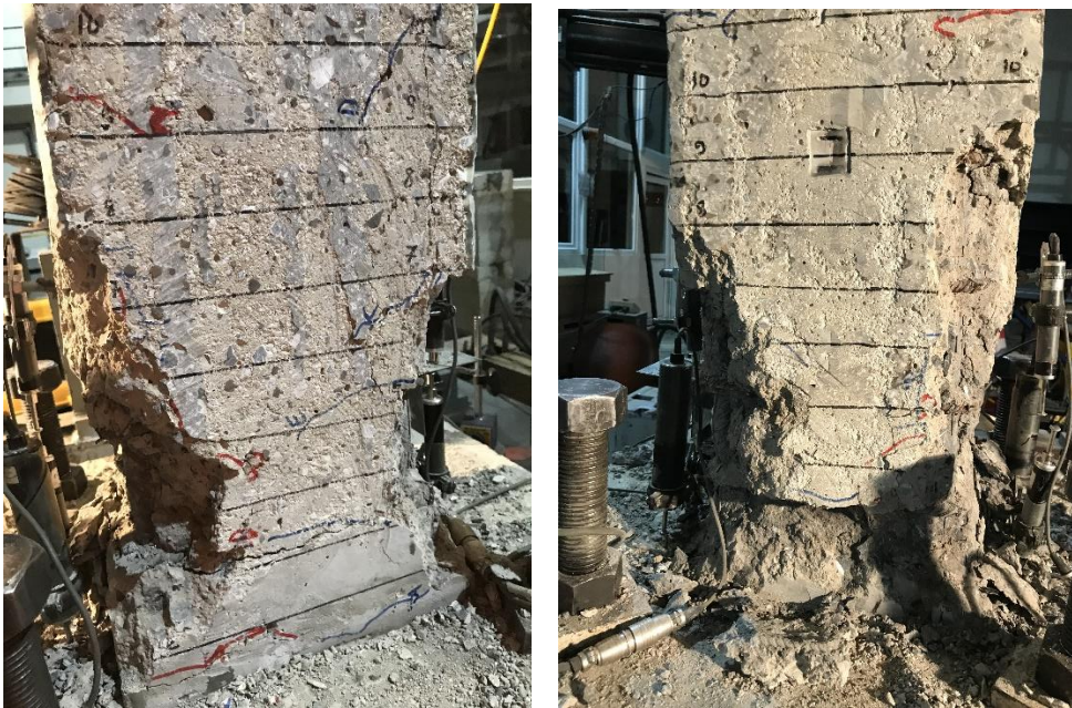
Şekil 4.68 : GDA-90M numunesi %6 öteleme oranı doğu (E) ve batı (W) yüzlerinin hasar görünümü.
