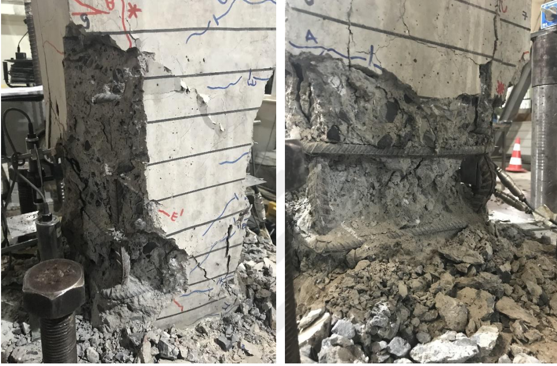
Şekil 4.26 : GDA-30M numunesi %6 öteleme oranı doğu (E) ve batı (W) yüzlerinin hasar görünümü.
