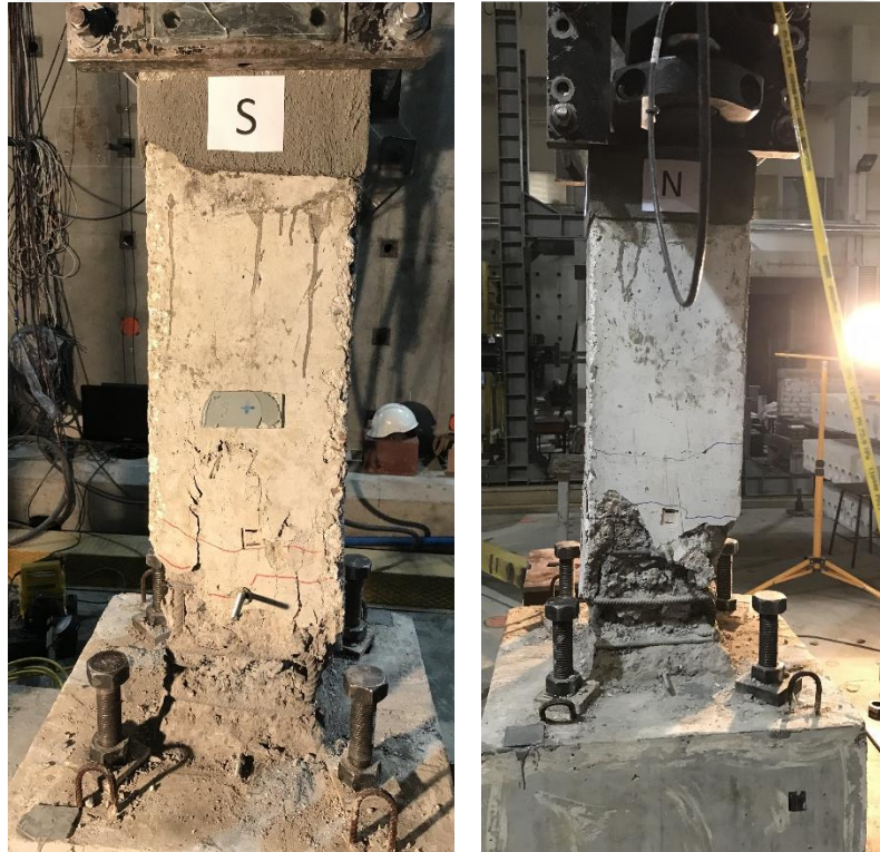
Şekil 4.50 : GDA-60M numunesi %6 öteleme oranı itme çevrimi batı (W) ve doğu (E) yüzlerindeki hasar görünümü.
