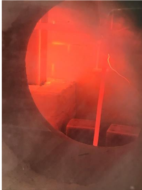
Şekil 3.4 : 30 dakikalık yangın deneyi sırasında gözlem penceresinden görünüm.
