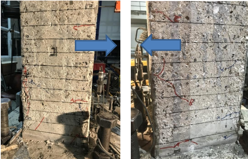
Şekil 4.61 : GDA-90M numunesi %2 öteleme oranı itme çevrimi batı (W) ve doğu (E) yüzlerindeki hasar görünümü.
