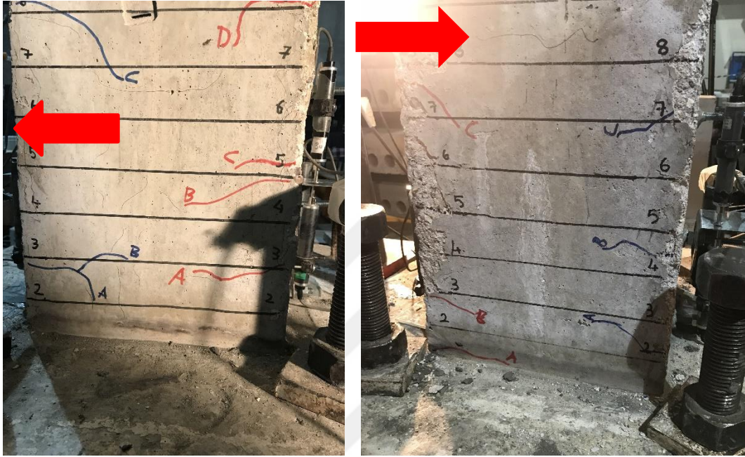
Şekil 4.39 : GDA-60M numunesi %1 öteleme oranı çekme batı (W) ve doğu (E) yüzlerinin hasar görünümü.
