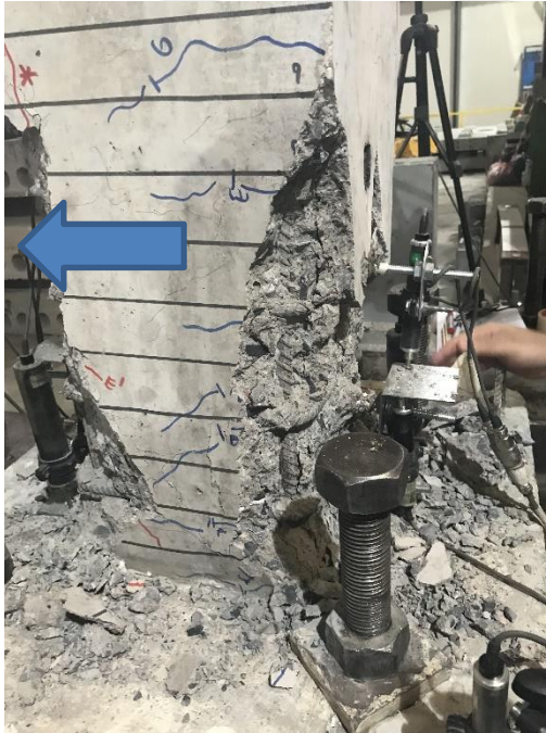
Şekil 4.25 : GDA-30M numunesi %5 öteleme oranı doğu (E) ve batı (W) yüzlerinin hasar görünümü.
