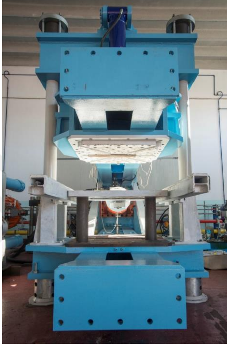
Şekil 3.29: Sismalab deprem yalıtım birimi test cihazı.
