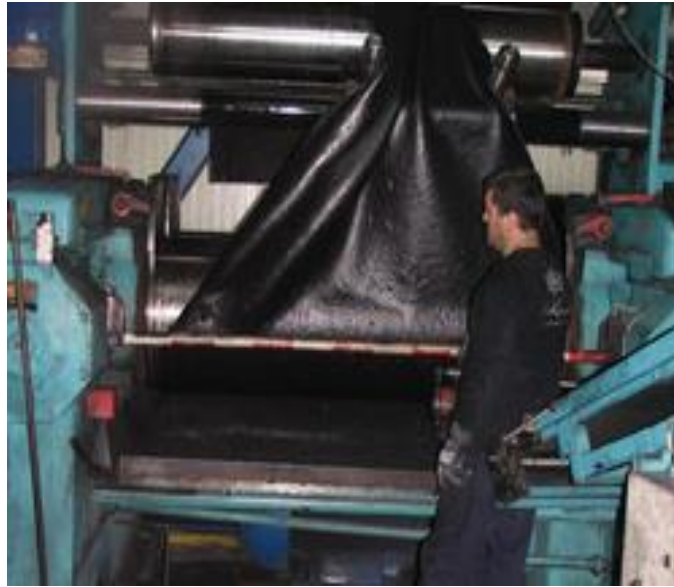
Şekil 2.6: Karışımın açık silindirlerde homojenize edilmesi.
