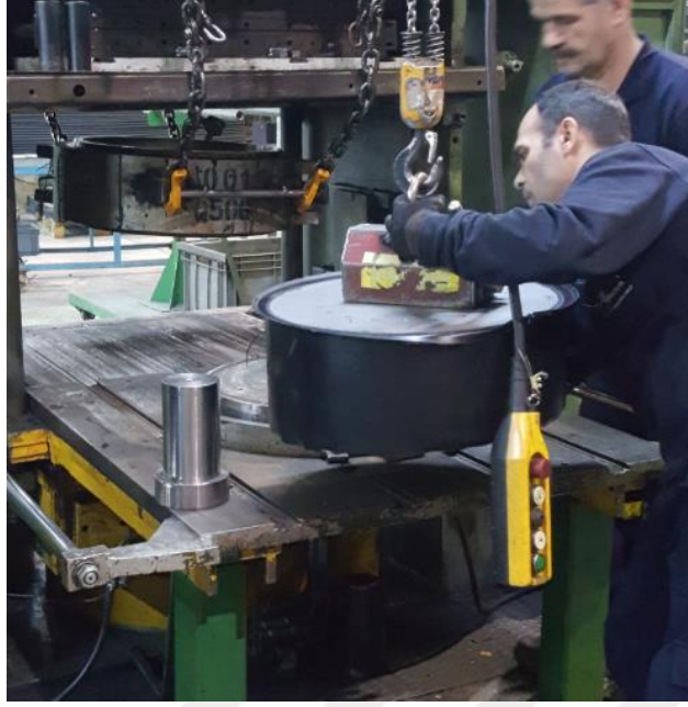
Şekil 2.10: Deprem yalıtım biriminin kalıptan alınması.
