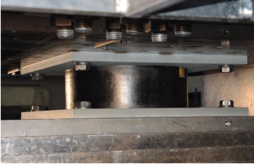
Şekil 3.28: Testleri tamamlanmış olan ARS001E18-2 deprem yalıtım birimi.
