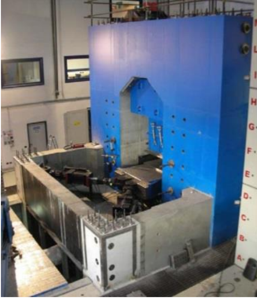
Şekil 3.12: Eucentre test merkezinde bulunan deprem yalıtım birimi test cihazı.
