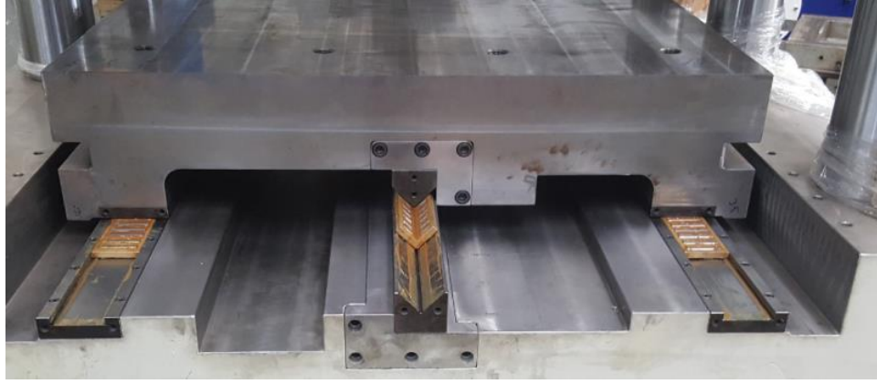
Şekil 3.7: Dinamik deprem yalıtım birimi test makinesi kayıcı sistemi.
