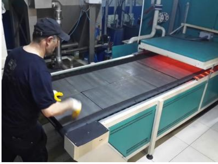
Şekil 2.8: İç çelik plakalara yapıştırıcı boya uygulanması.
