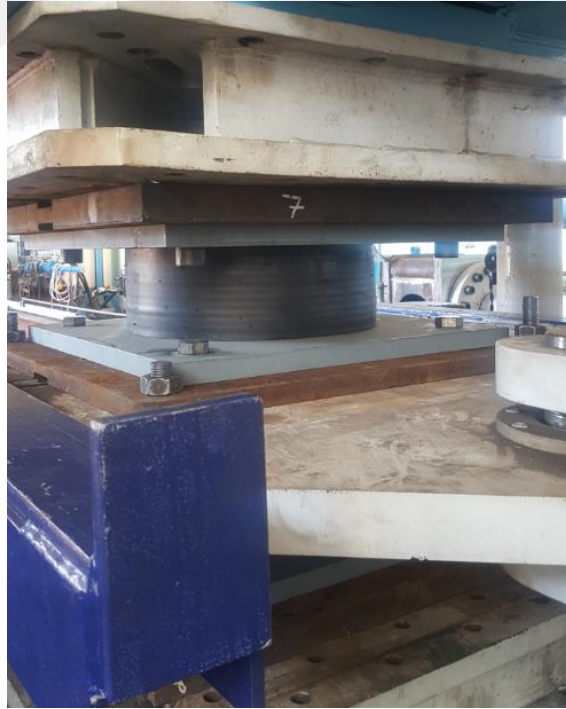
Şekil 3.32: Deprem yalıtım birimleri düşey rijitlik testi sırasında.
