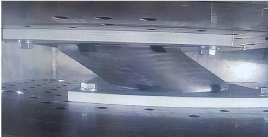
Şekil 3.27: ARS001E18-1 deprem yalıtım birimi yatay kapasite testinde.
