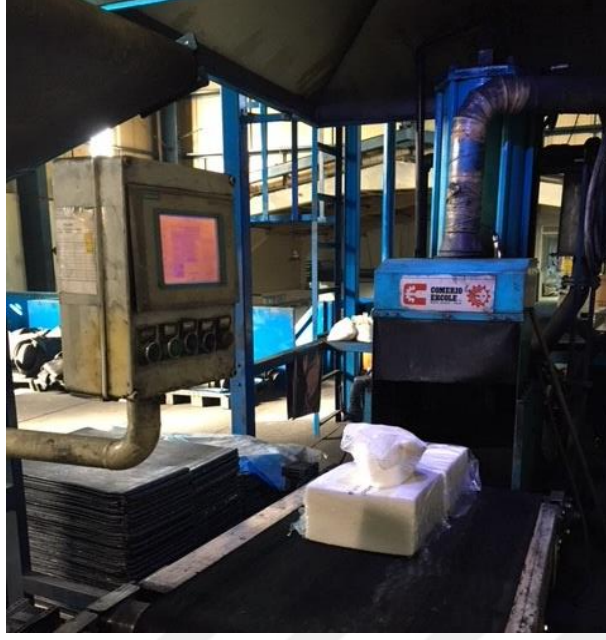
Şekil 2.5: Hazırlanan bileşenlerin karıştırıcıya iletilmesi.
