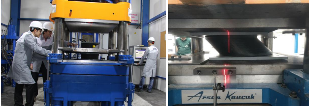
Şekil 3.9: Yapışma direnci kontrolü için üretilen elastomer yalıtım birimi testleri.
