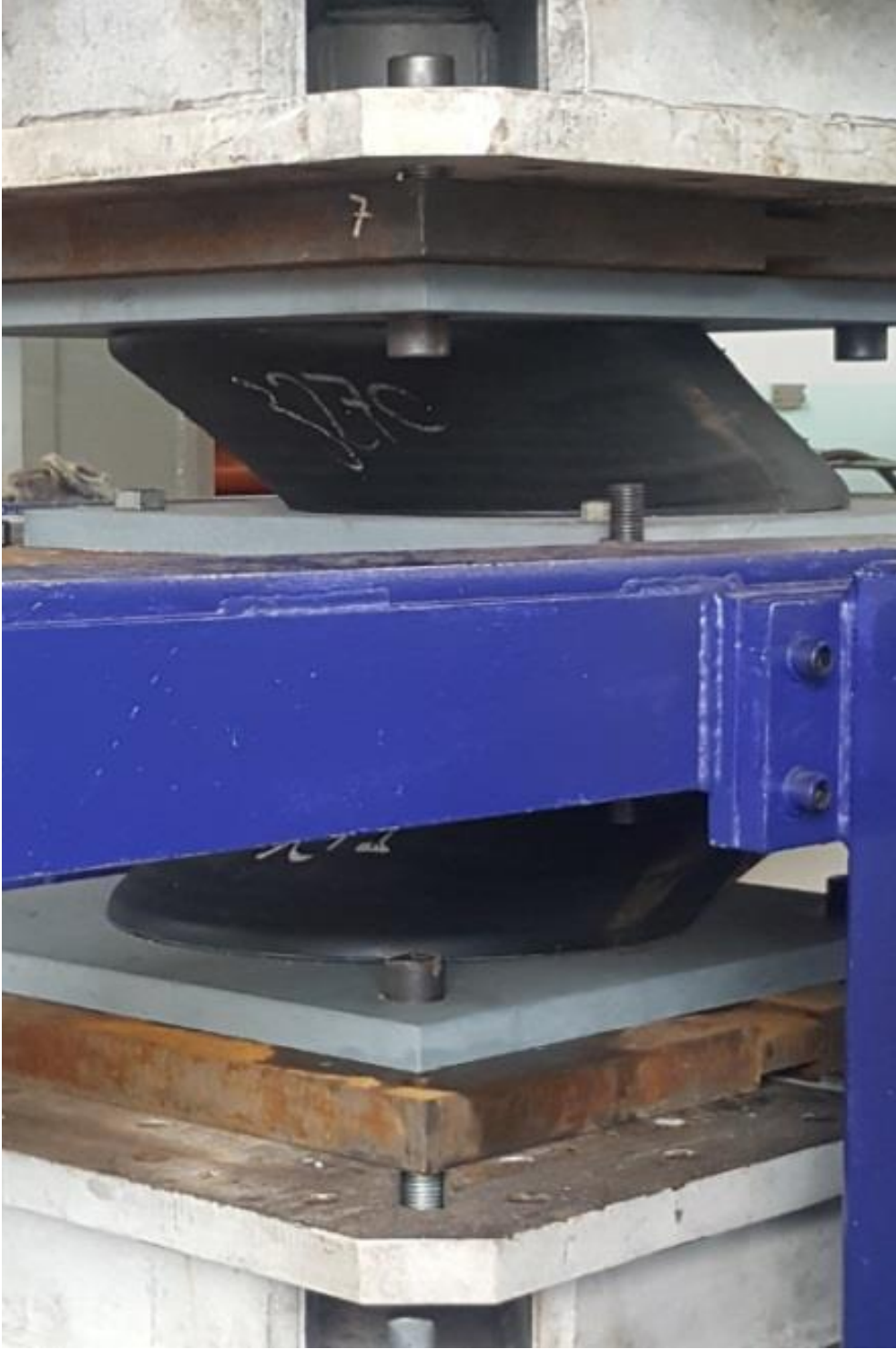
Şekil 3.50: Testler sırasında %100 kayma birim şekil değıştirmesi yapan deęişim yalıtım birimleri.
