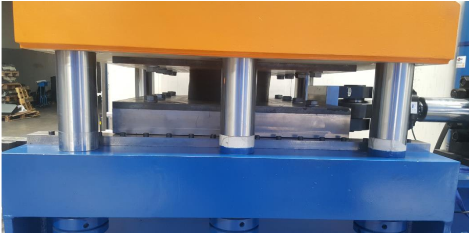
Şekil 3.5: Bir kurşun çekirdekli kauçuk yalıtım birimi dinamik test makinesinde deneme testinde.
