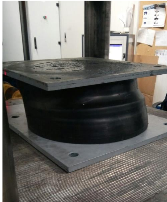
Şekil 3.10: Kurşun çekirdekli kauçuk yalıtım birimi numunesinde büyük yanal şekil değiştirmeler altında yaşanan kauçuk ile iç çelik plakalar arası yapışma problemi.
