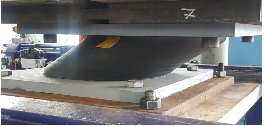
Şekil 3.55: Maksimum düşey yükte maksimum yatay kapasite testi sırasında deprem yalıtım biriminin durumu.
