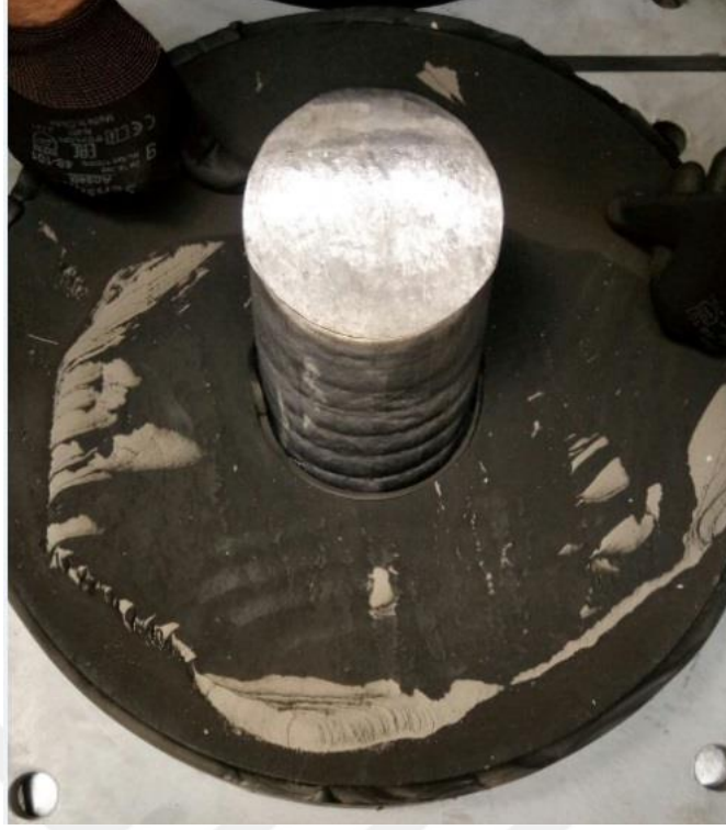
Şekil 3.11: Problemin olduğu katmanın kesilmesi sonucu ortaya çıkan durum.
