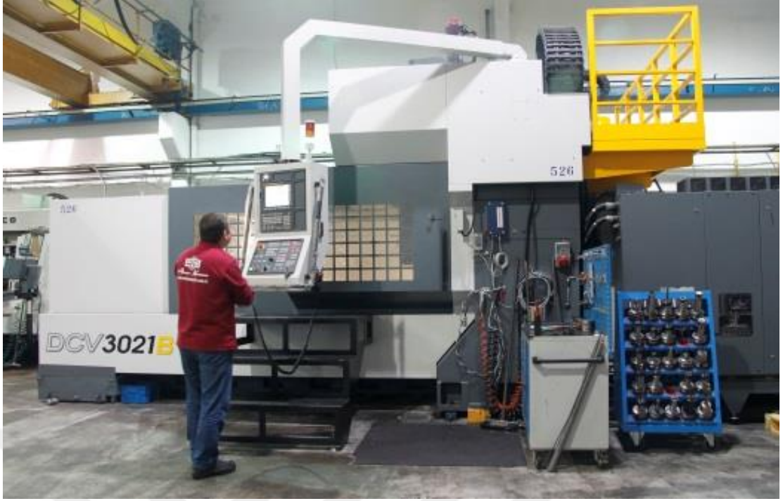
Şekil 2.7: Deprem yalıtım birimi kalıplarının hazırlandığı bir CNC makinesi.
