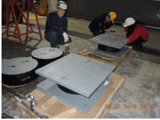
Şekil 3.13: Eucentre test merkezinde test edilen kurşun çekirdekli kauçuk yalıtım birimleri.
