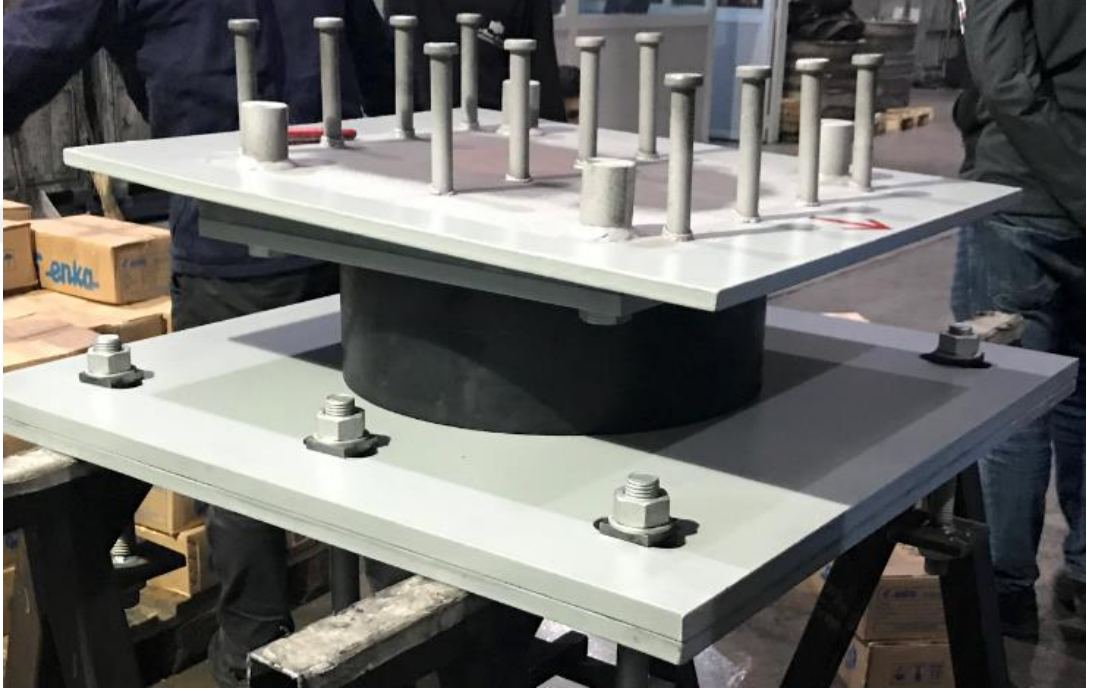
Şekil 2.14: Montajı tamamlanmış bir kurşun çekirdekli kauçuk yalıtım birimi.
