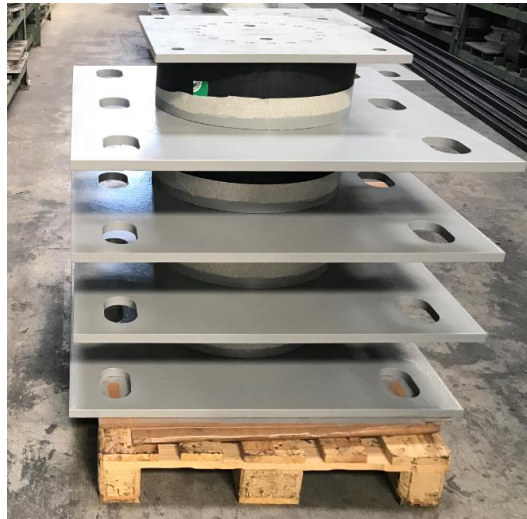
Şekil 2.13: Korozyon koruması tamamlanmış kurumaya bırakılan deprem yalıtım birimleri.
