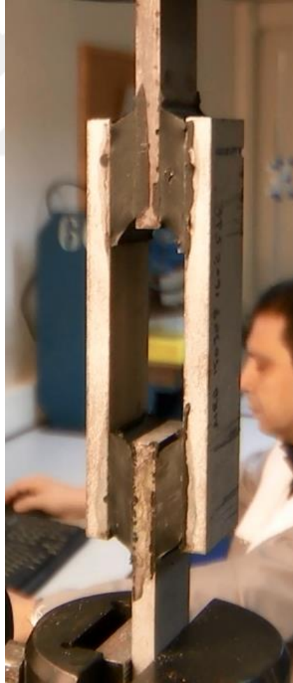
Şekil 3.2: Dinamik kayma modülü tayini testi.
