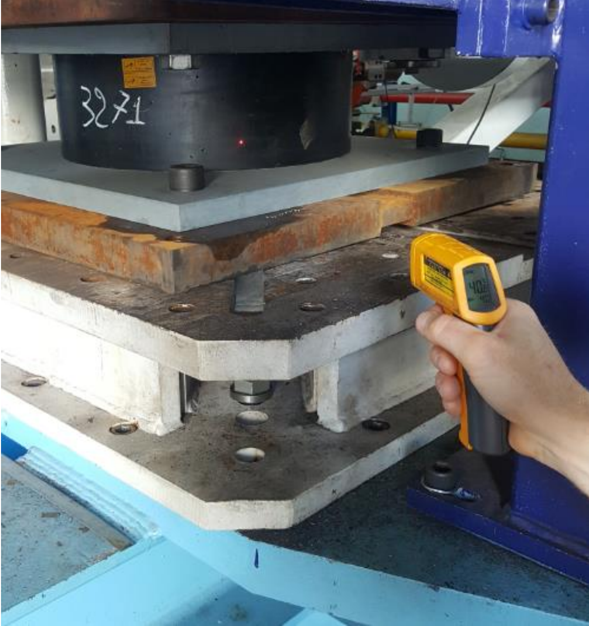
Şekil 3.49: Testler öncesi deprem yalıtım birimlerinin sıcaklıkları ölçülmektedir.
